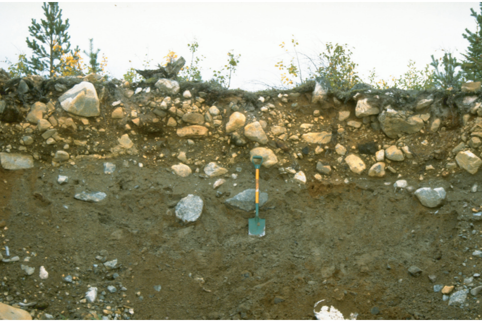
Fig. 4. En ordinär morän, täckt av knappt en meter stenigt grus. Ytlagret är ett resultat av forntida havsvågras svallning. Ytor där liknande lagerföljder kan förväntas betecknas på kartan som morän med hårt svallat ytiskt (se avsnittet om morän). Foto: Lars Rodhe. Sandy till covered by one metre of wave-washed gravel. This type of terrain is classified as "til" with a strongly wave-washed surface layer".
