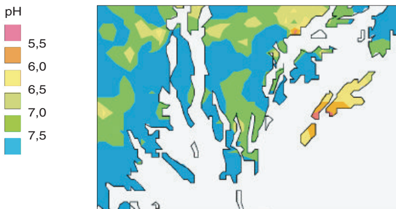
Fig. 64. Surhet. pH-värdena i bergbrunnarnas vatten är i allmänhet något högre än i de flesta områden i Sverige. Det beror sannolikt på förekomsten av vittringsbenägna bergarter (kalkrika). Några omfattande problem med surt brunnsvatten torde inte förekomma.
