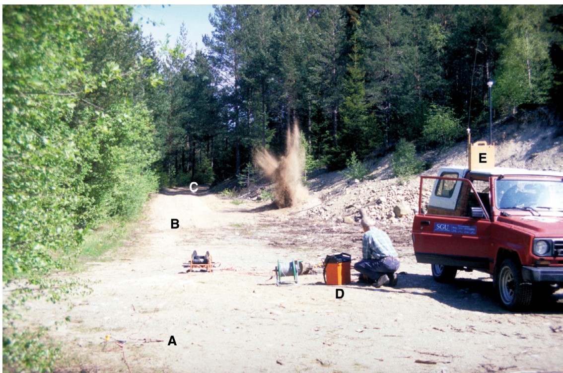
Fig. 4. Vid seismiska mätningar detoneras en mindre dynamitladdning och ljudvågorna som fortplantar sig i marken registreras av geofoner vid A, B och C. D är seismograf som ritar upp och lagrar kurvor för ljudvågornas utbredning. E är GPS-mottagare för positionering. Från undersökningarna vid Vinarträsket, avsnitt 100–200 m i profil S3-98, figur 49. Foto: Carl-Fredrik Müllern.
