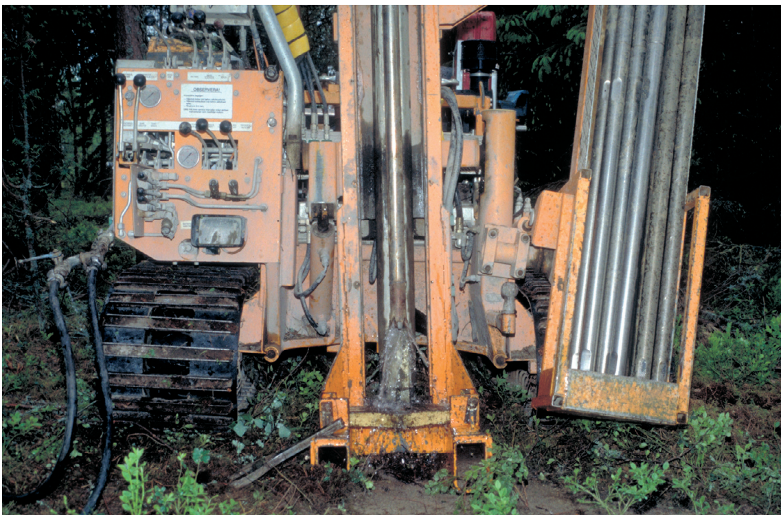
Fig. 17. Vissa lager vid Enbymalmen och vid grundvattendelaren mellan Fagersjön och Grindsjön var mycket hårt packade och svårborrade. För att underlätta borrhningen användes vattenspolning. Samtidigt som borkronan roteras och slås nedåt spolas vatten ut, vilket löser upp de hårdpackade jordlagren. Foto: Carl-Fredrik Müllern.
