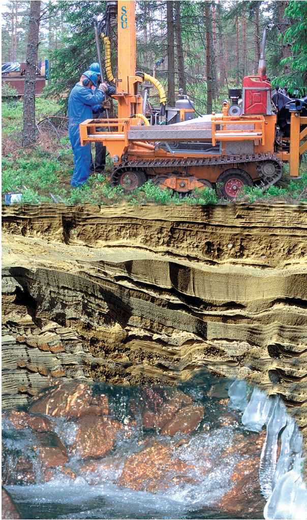
Fig. 18. Fotomontage som ger en bild av hur man med borrhinar söker höga och låga berglägen – grundvattendelare och grundvattenmagasin. På sådana ställen under isälvsavlagringens sand och grus, där bergytan ligger högre än grundvattenytan kan man inte ta ut vattnet i brunnar. Vattnet rinner av på bergytan och ner i intilliggande grundvattenmagasin. Foton: Carl-Fredrik Müllern.
