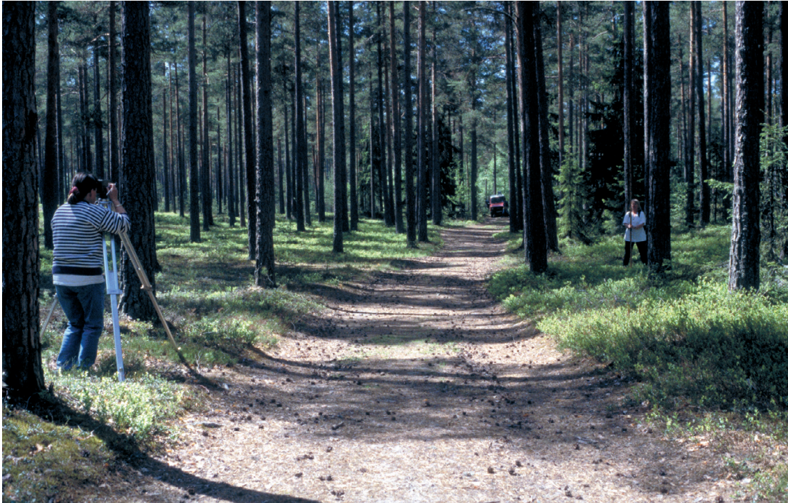
Fig. 5. Geofysiska profiler avvägs för att erhålla exakta mått på marktytor, jordartsgränser, grundvattenytor och bergtytor. Foto: Carl-Fredrik Müllern.
