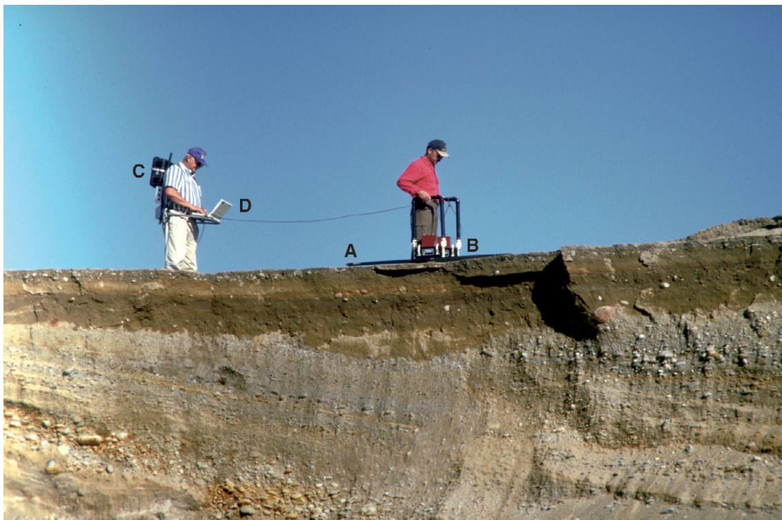
Fig. 3. Georadarmätningar ger information om lagerstrukturer och grundvattenytor. A och B är antenner för sändning och mottagning, C är styrenhet för datainsamling och D är dator med bildskärm. Jämför med figur 7. Foto: Carl-Fredrik Müllern.
