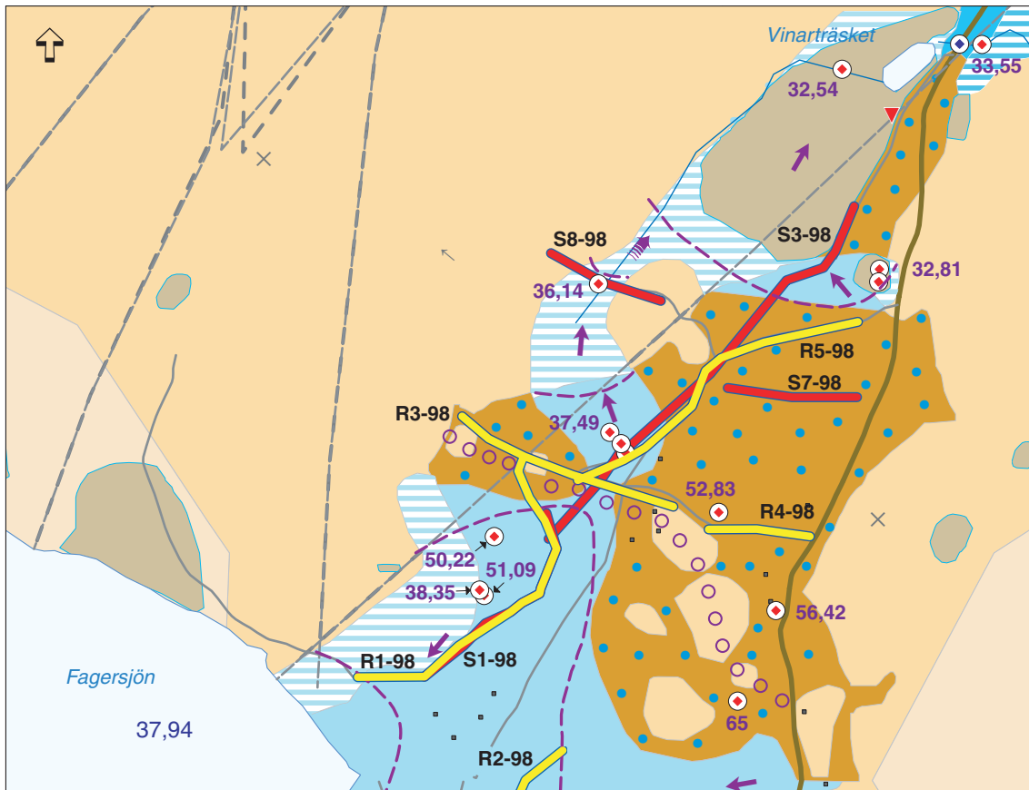
Fig. 49. I området norr om Fagersjön har ett förhållandevis omfattande arbete lagts ner för att fastställa grundvattendelarens läge. Lägga märke till de två grundvattenvåningarna med nivåer på 51,09 och 38,35 m ö.h. på samma plats.
