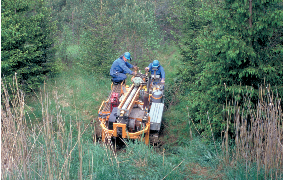
Fig. 6. Borrbandvagnen har bra framkomlighet i terrängen. Foto: C.-F. Müllern.
