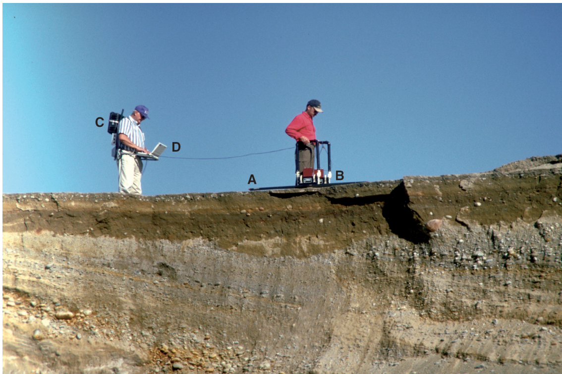
Fig. 2. Georadarmätningar ger information om lagerstrukturer och grundvattenytor. A och B är antenner för sändning och mottagning, C är styrenhet för datainsamling och D är dator med bildskärm. Foto: C.-F. Müllern.
