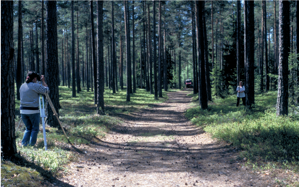
Fig. 4. Geofysiska profiler avvägs för att erhålla exakta mått på markytor, jordartsgränser, grundvattenytor och bergytor. Foto: C.-F. Müllern.
