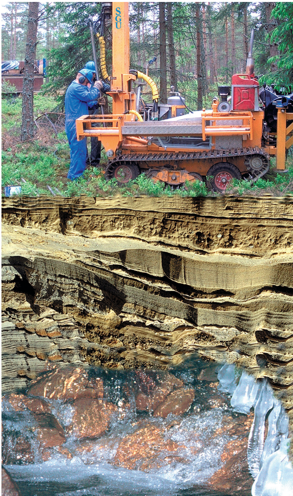
Fig. 7. Fotomontage som ger en bild av hur man med borring söker höga och låga berglägen – grundvattendelare och grundvattenmagasin. På sådana ställen under isälvsavlagringens sand och grus där bergytan ligger högre än grundvattentytan kan man inte ta ut vatten i brunnar. Vattnet rinner av på bergytan och ner i intilliggande grundvattenmagasin. Foton: C.-F. Müllern.
