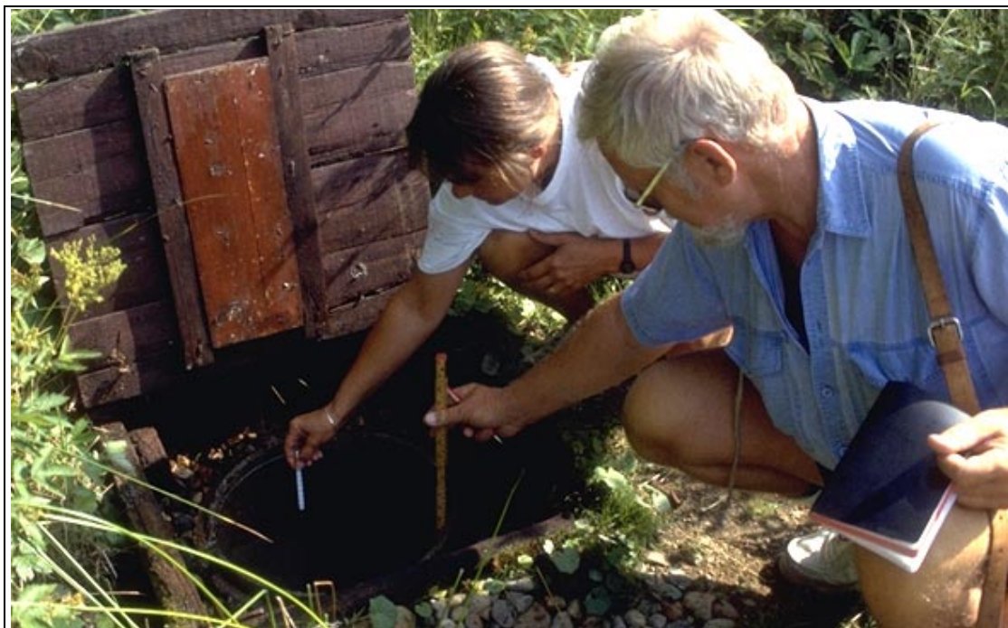
Fig. 2.a. Fältarbetena med undersökning av grundvattenförhållandena inleds med brunnsinventering och källinventering. Här mäts temperatur och grundvattennivå i en brunn, som ursprungligen var en fritt flödande källa. Ca 500 m norr om Strängnäs flygplats. Foto C.F. Müllern 1994.
