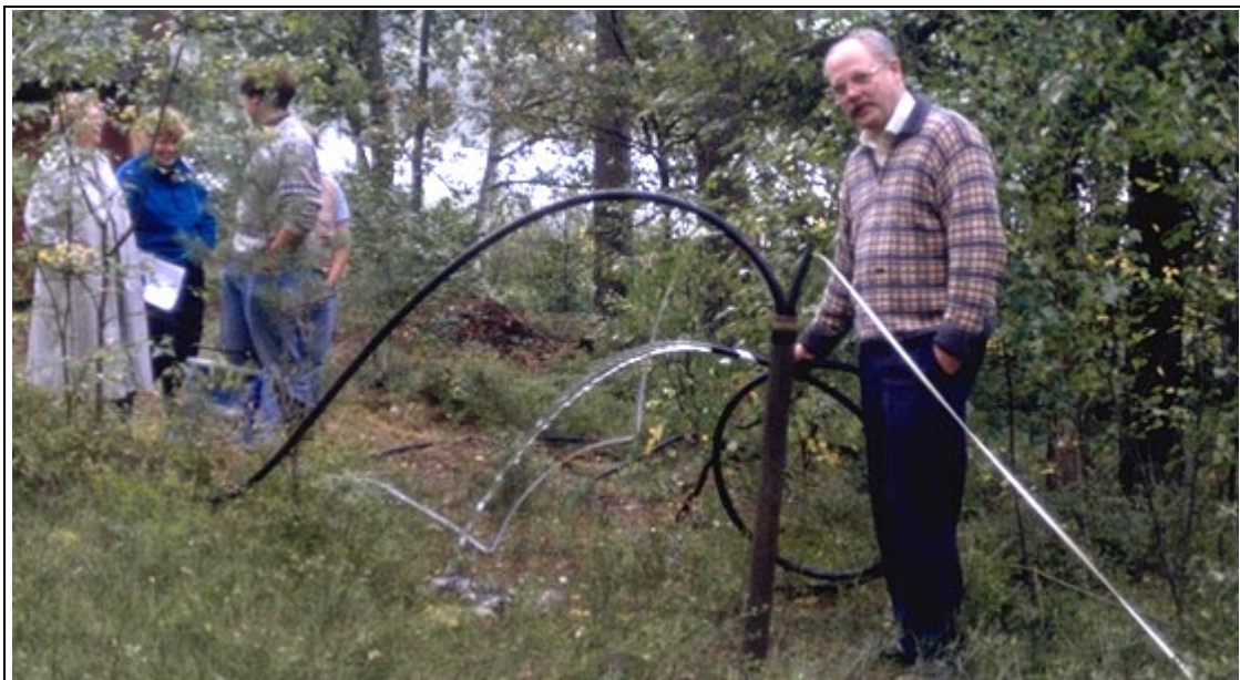
Fig. 2.h. Provpumpning med omsättning av ca 2 000 l vatten före provtagning för kemisk analys. Intill badplatsen vid västra stranden av Visnaren. Foto C.F. Müllern 1994.
