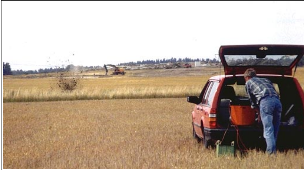
Fig. 2.e. Seismiska mätningar på Lida gårde. Bilden visar en detonation. Tryckvågen registreras av mätinstrument i bilen. Sand- och gruslagren under leran visade sig i detta område vara förhållandevis tunna. Möjligherna till grundvattenuttag torde vara någon enstaka liter per sekund. Foto C.F. Müllern 1994.
