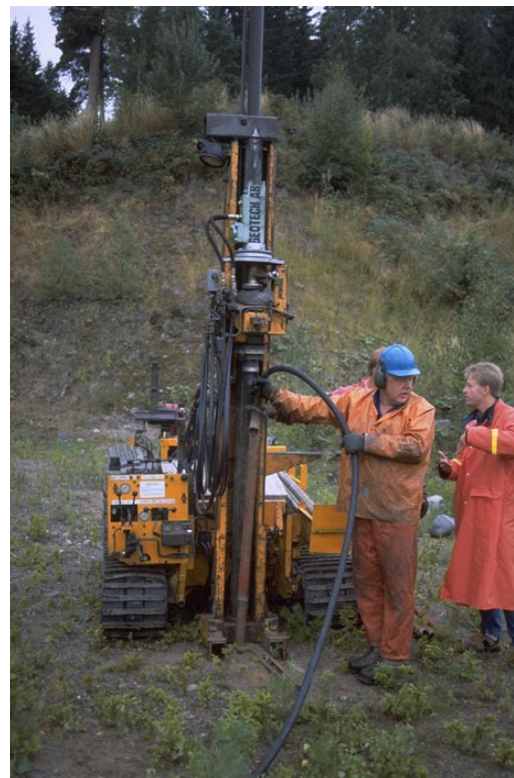
Fig. 2.h. Bormaskinen av märket Geotech 604 används för sondering (bestämning av jordlager och djup till berg), jordprovtagning och vattenprovtagning samt för etablering av observationsrör. Foto H. Söderholm 1995.
