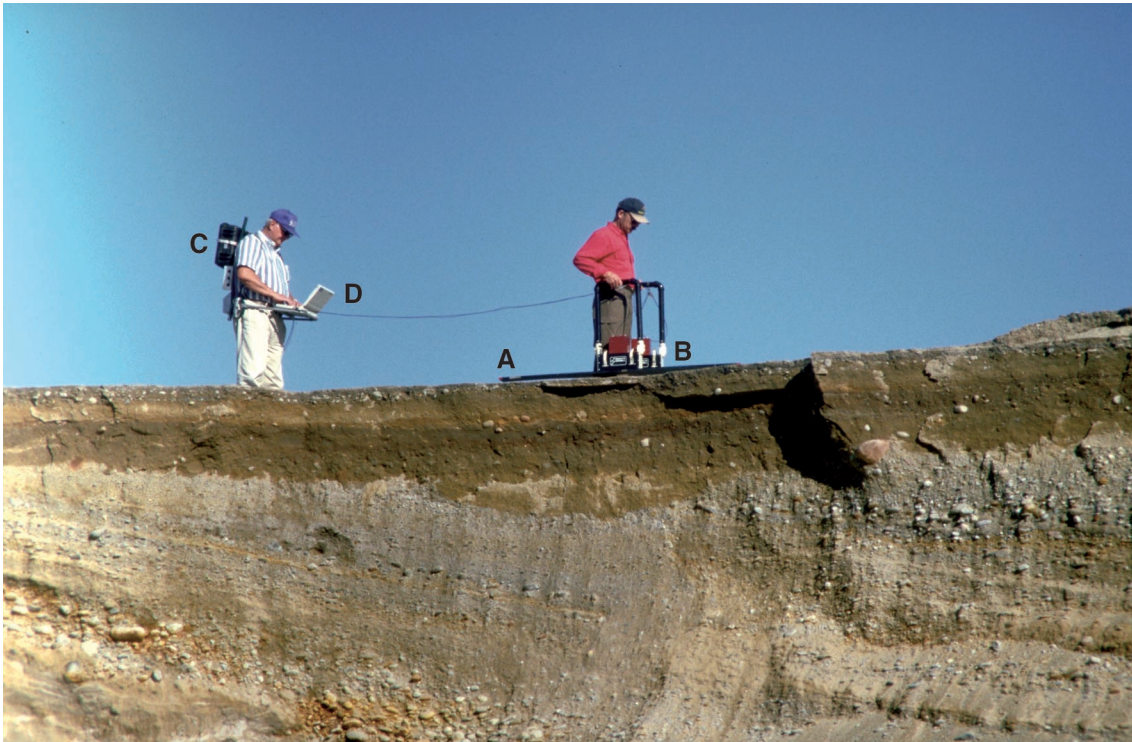
Fig. 2.1. Georadarmätningar ger information om lagerstrukturer och grundvattenytor. A och B är antenner för sändning och mottagning, C är styrenhet för datainsamling och D är dator med bildskärm. Foto: Carl-Fredrik Müllern 1998.
