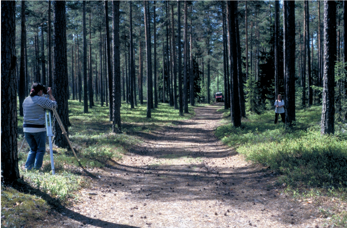
Fig. 2.3. Geofysiska profiler avvägs för att erhålla exakta mått på markkytor, jordartsgränser, grundvattenytor och bergytor. Foto: Carl-Fredrik Müllern 1997.
