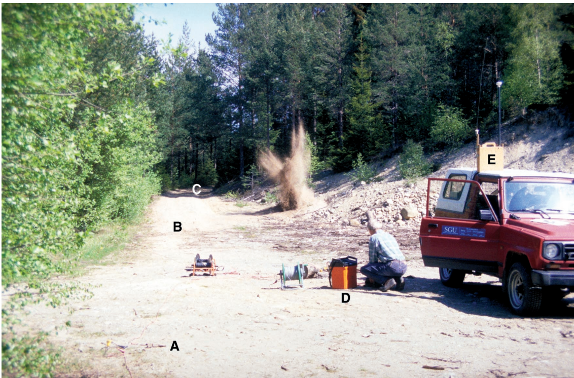
Fig. 2.2. Vid seismiska mätningar detoneras en mindre dynamitladdning och ljudvågorna som fortplantar sig i marken registreras av geofoner vid A, B och C. D är en seismograf som ritar upp och lagrar kurvor för ljudvågornas utbredning. E är en GPS-mottagare för positionering. Foto: Carl-Fredrik Müllern 1998.
