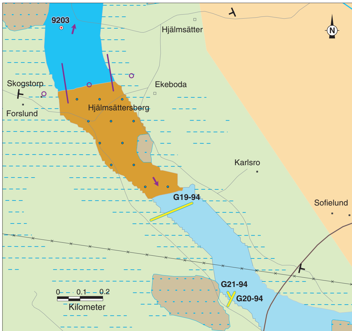
Fig. 3.4.3.a. Grundvattendelare i förmodat torrt parti i Köpingsåsen.
