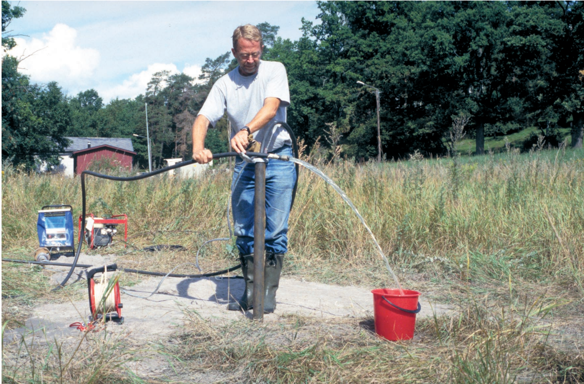
Fig. 2.7. Efter omsättning av drygt 1 000 liter vatten tas ett prov från observationsröret för fullständig kemisk analys. Foto: Carl-Fredrik Müllern 1997.
