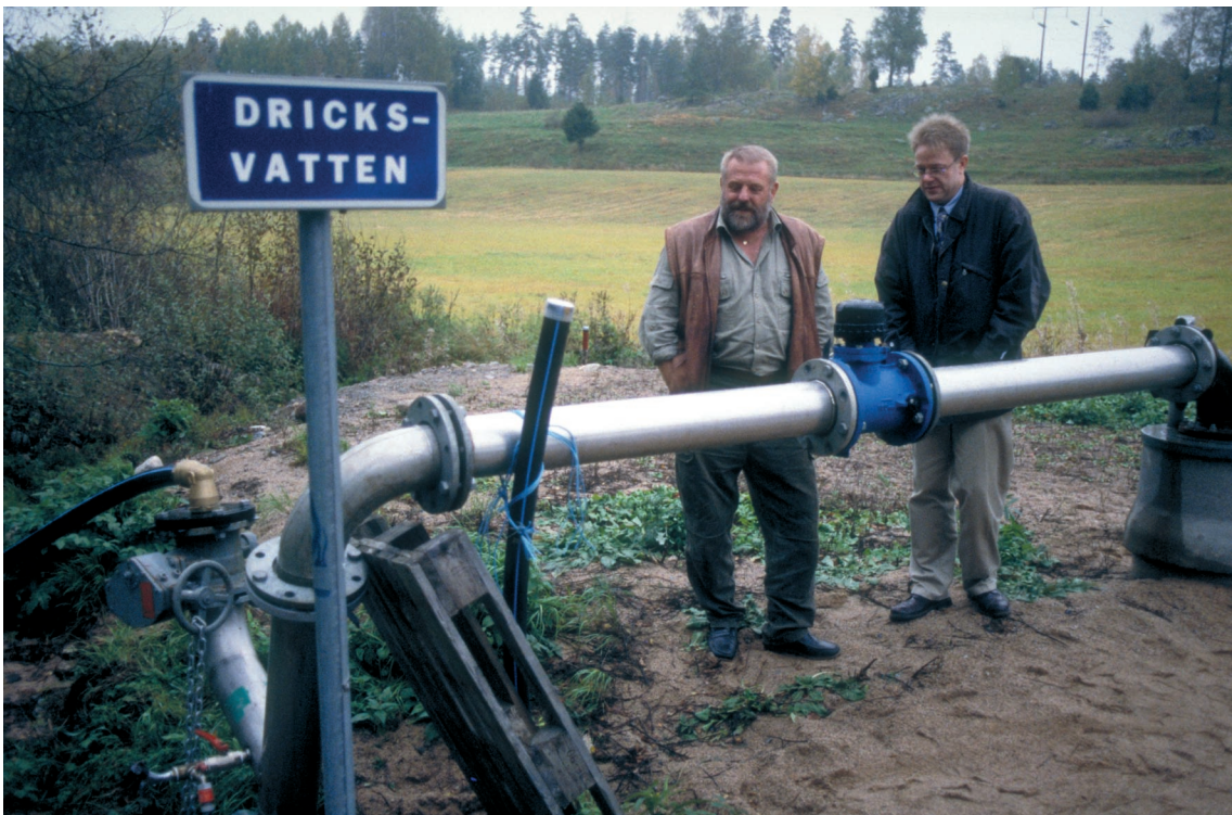
Fig. 2.12. Anordning för långtidsprovpumpning av rörfilterbrunnen vid Hännicketäppans källa. Brunnen är numera överbyggd och kommunal vattentäkt för bl.a. Forssjö samhälle. Foto: Hans Söderholm 1997.
