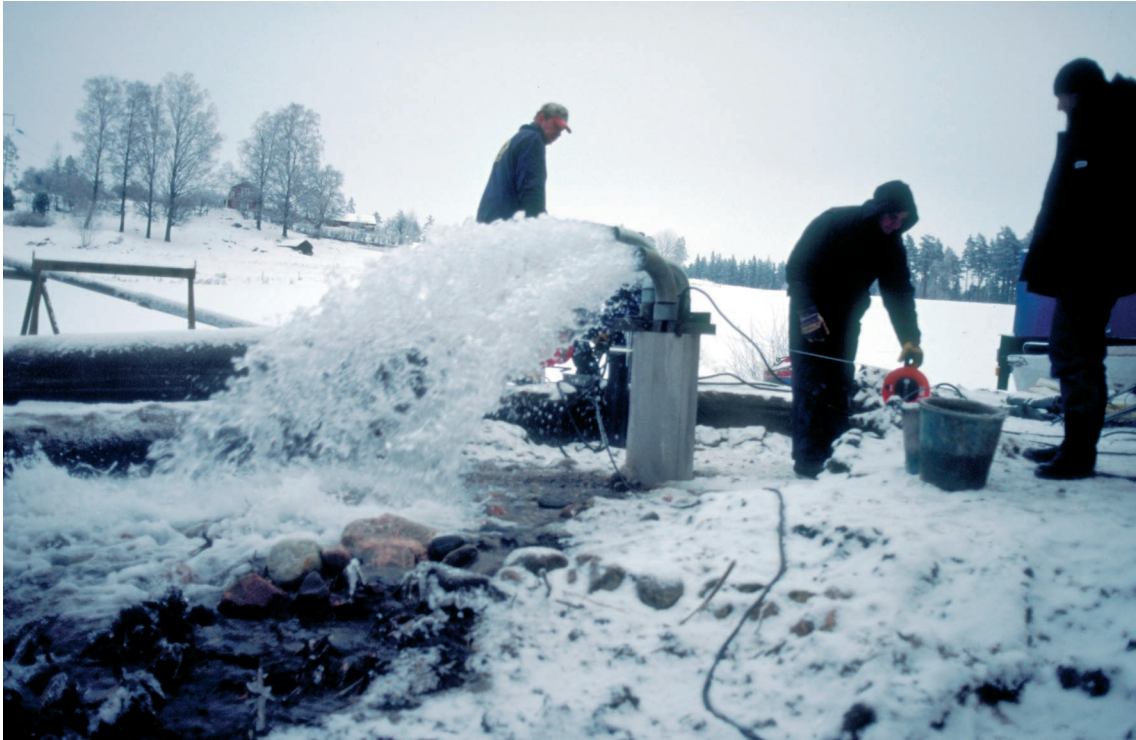
Fig. 2.11. Stegprovpumpning med 60 liter per sekund av rörfilterbrunn, S I, vid Hännicketäppans källa i januari 1997. Foto: Hans Söderholm 1997.
