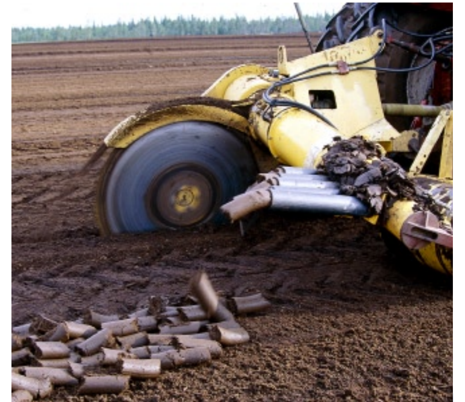
SGU tar årligen fram statistik om torvproduktionen. Bilden visar framställning av torvbriketter vid Norrheden, Villhelmina.
