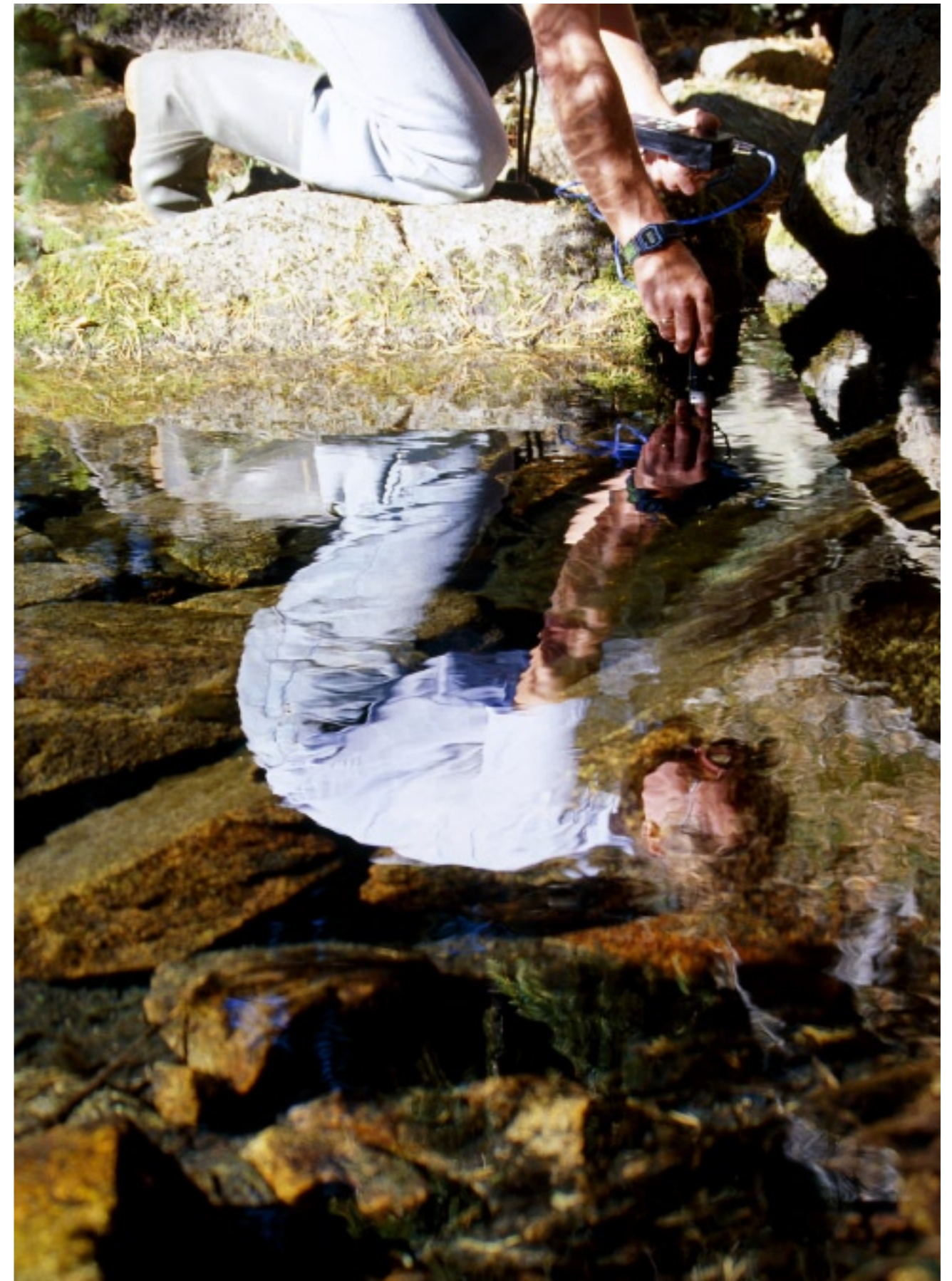
En hydrogeolog mäter strömningshastigheten vid Ulebo källa i Uppland.
