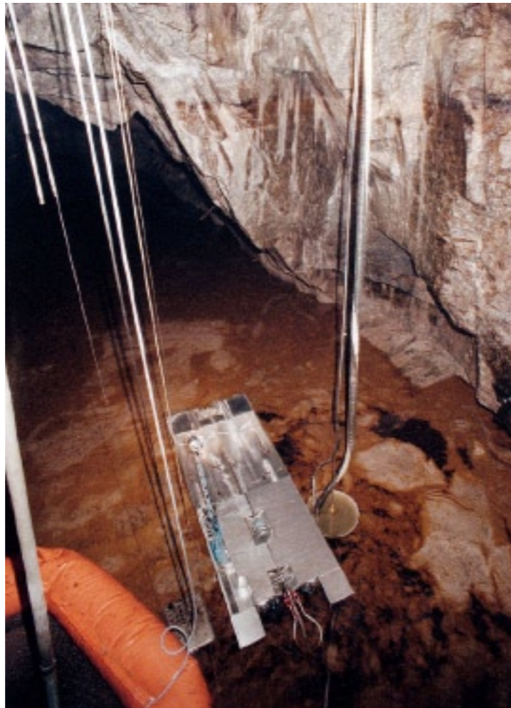
SGU använder en fjärrstyrd katamaranfarkost för sanering av bergrum.
