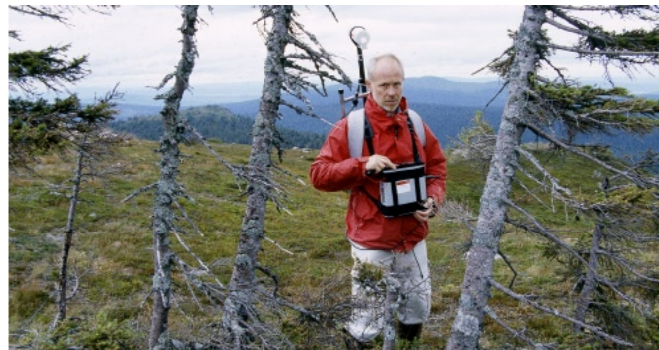
Geofysisk mätning av den magnetiska flödestätheten nära Arvidsjaur i Lappland. Den insamlade informationen används främst vid berggrundskartläggning och vid prospektering efter malmer.
