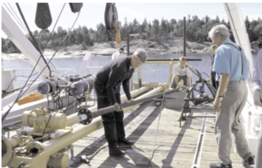
Lossning av borrhör ombord på SGUs forskningsfartyg Ocean Surveyor i Norrtäljeviken.
