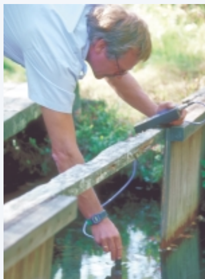
Strömhastighetsmätning i Tärnsjö, Uppland.
