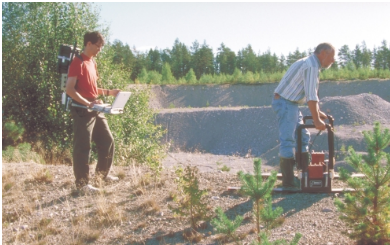
Georadarmätning vid Runhällen i Uppland.
