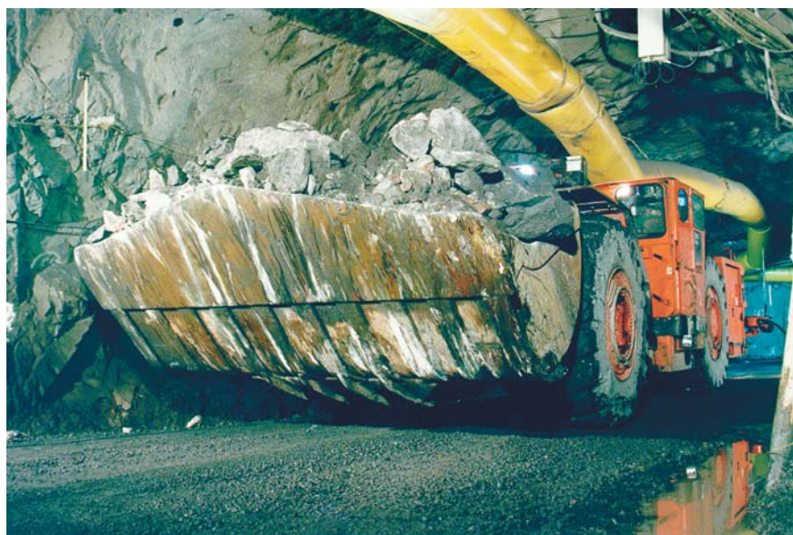
Automatiserad uttransport av järnmalm i Kirunagruvan. Foto: LKAB.
