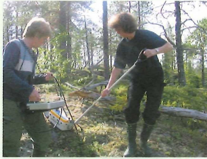
Test av ny markradarteknik för detektering av små sprickor i berg.
