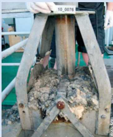
Vänstra bilden: sediment av cellulosa, som tagits upp med SGUs provtagare. Högra bilden: sediment med lukt av petroleum från en äkta "fiberbank".
