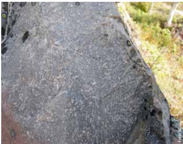
Exempel på en bergart med mycket bra tekniska egenskaper för vägbyggen. Det är en grå, mycket finkornig till tät, porfyrisk metavulkanit som till exempel används för högt trafikerade motorvägar.
