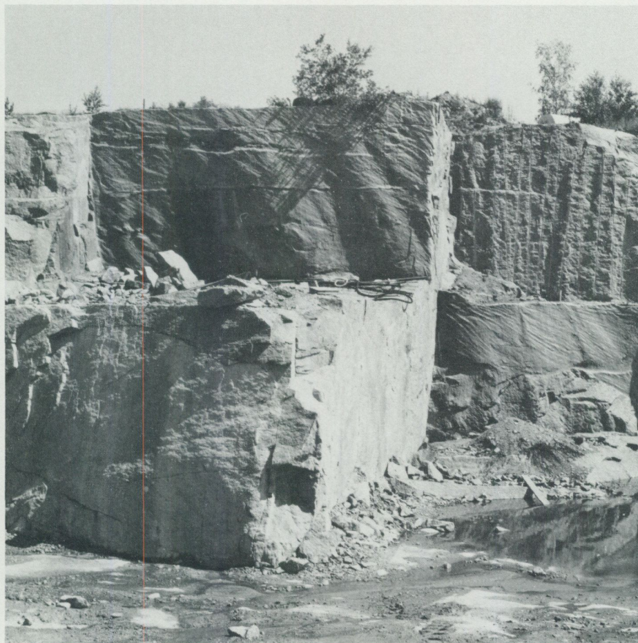
Fig. 8. Jetskurna ytor och, uppe till höger, kilsömborrade brytfront i Askaremåla- eller Göttemargranit nära Kräkemåla, i AKF:s storbrott (63724/15506). Foto P. H. Lundegårdh 1981.
