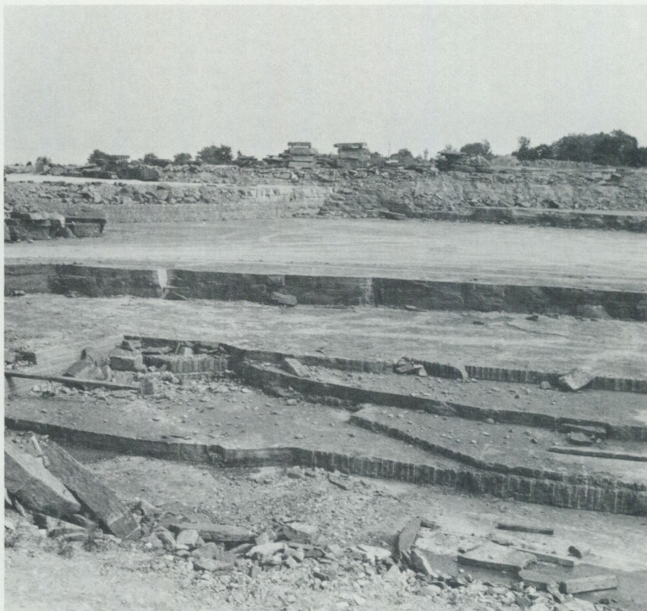
Fig. 9. Tät pallbrytning i nyöppnat ortoceratitkalkstensbrott nära Hornsudden, Öland (63415/15664). Foto P. H. Lundegårdh 1981.
