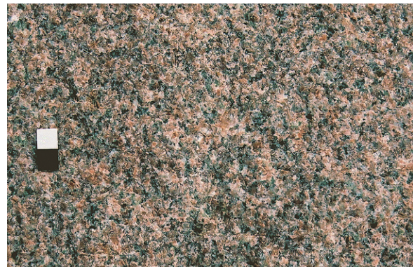
Fig. 20. Röd alkalifältspatgranit. Stenbrott N om Brånahult, 4G Kalmar NV (6295600/1500950). Skalan 2 cm. Foto Hugo Wikman 2002.
