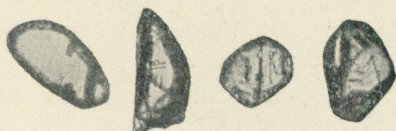
Korn af ett titanitliknande mineral. × 50. Alla kornen äro ställda så, att deras utsläkningsriktning ligger vertikalt.
