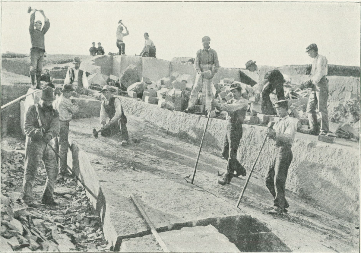
Stenbrott i Bohuslänsgranit på Malmön utanför Lysekil, visande granitens utpräglande bankning.
