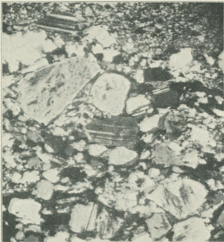
Fig. 2. Fältspatrikt skikt med grövre, klastisk struktur i kontakt med finkornigt skikt (överst i bilden). Ramhällsfältet. Först. 35 ggr. Nic. +.
