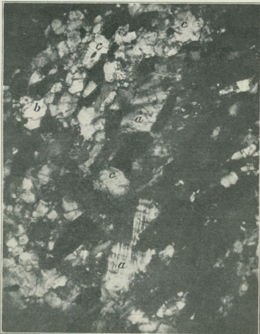
Fig. 9. Rödpigmenterade, nästan opaka mikroklintavlor (a) i hämatitbandad leptit från Ramhäll. Vissa tavlor granulerade och då fria från pigment (b) eller inneslutande järnglans (c). Först. 52 ggr. Nic. +.
