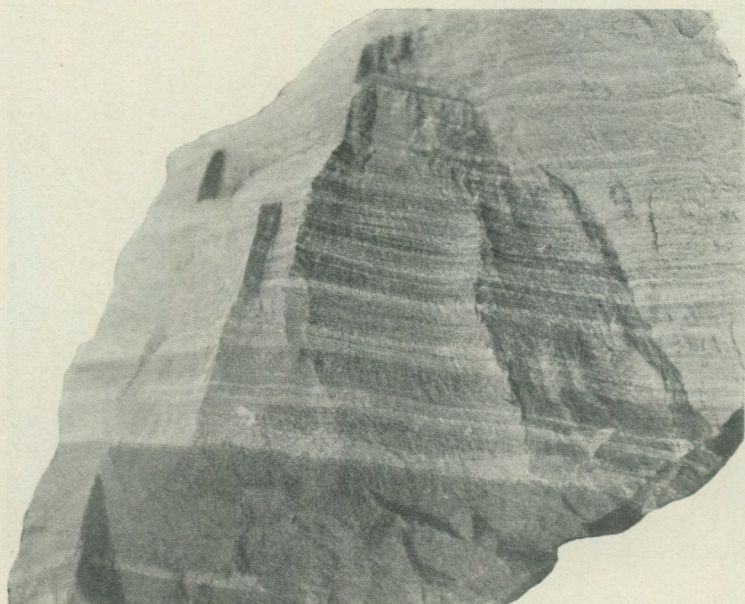
Fig. 37. Skarnbandad leptit från sedimentserien vid Norra Koltorp. De mörka lagren utgöres av hornbländeskarn, de ljusa äro leptitskikt. I nedre kanten av det bredaste skarnlagret synes ett malmskikt. \frac{1}{4} nat. storlek.
