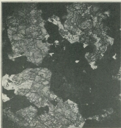
Fig. 31. Magnetit (svart) i granit vid kontakten mot malmbrottstykke. Transättra gruva. (a) epidot, (b) plagioklas. Först. 52 ggr. Ordinärt ljus.
