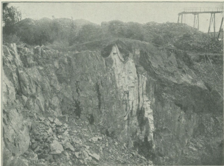
Fig. 36. Dolomitiska kalkstenspartier (ljusa) helt omslutna av skarnmassor (mörka) och utgörande rester av den stora kalkstenslins, ur vilken skarnet framgått. Östansmossgruvan i Röbergsfältet, Norberg.
