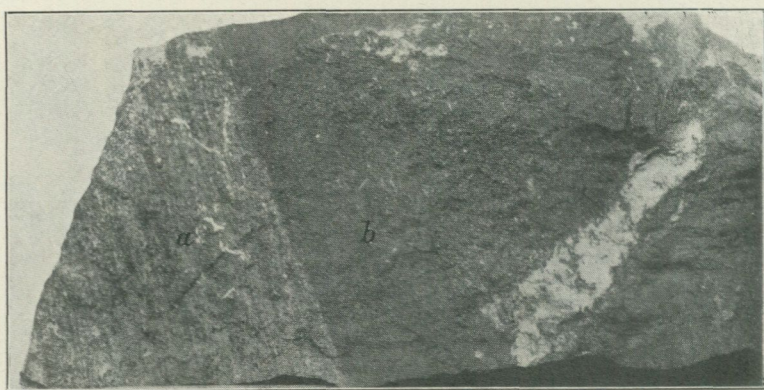
Fig. 14. Kontakt mellan granatskarn (mörkt), uppträdande som lager i kalksten, och skiktad, magnetitförande kalksten från Maskingruvan, Ramhäll. \frac{1}{5} nat. storlek.
