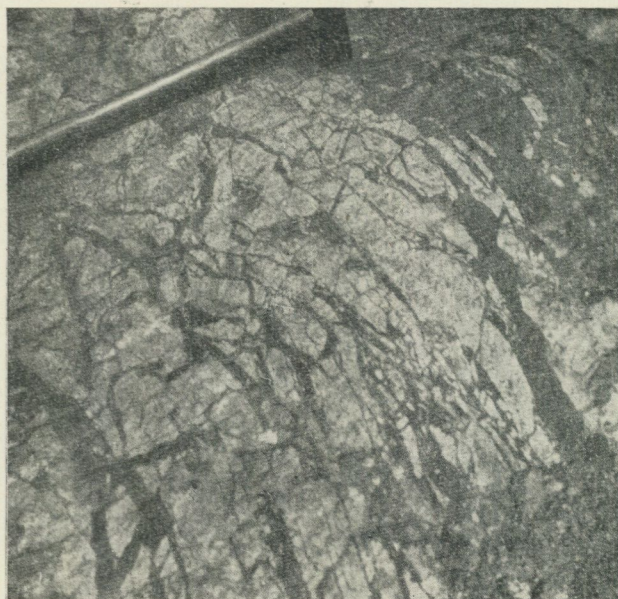
Fig. 5. Malmbreccia, Tuolluvaara. Magnetiten är mörk, porfyren ljus.
