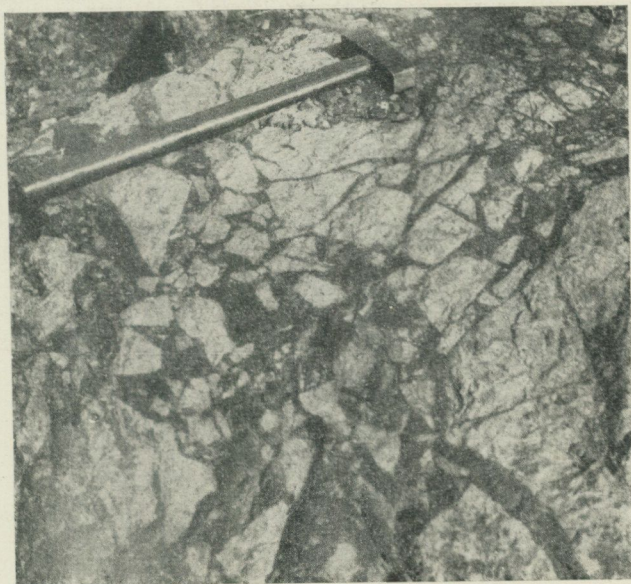
Fig. 6. Malmbreccia, Tuolluvaara. Magnetiten är mörk, porfyren ljus.
