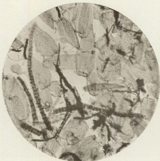
Fig. 27. Fuscumtorv H 4 R 0 V 0 . — Grundmassan består av stammar och blad av Sphagnum fuscum . Bladen befinna sig i begynnande upplösning och hava i allmänhet lossnat från stammarna.
