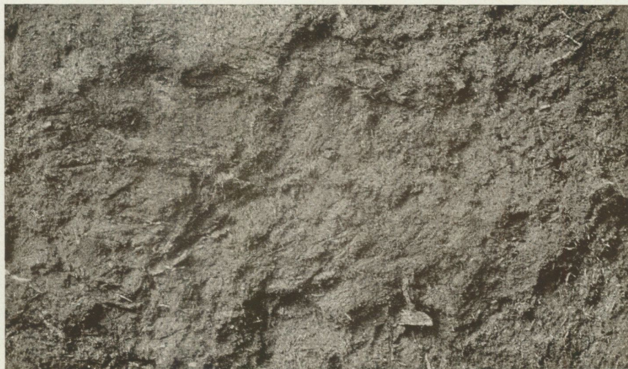
Fig. 13. Lågstarrtorv H_0R_1Vo . — En nästan strukturlös mylla med enstaka rottrådar och rotstockar av starr.
