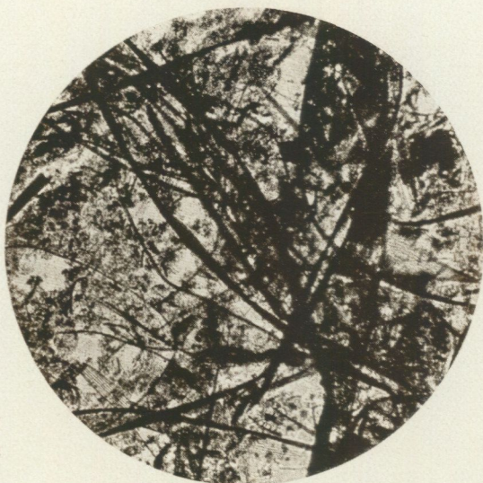
Fig. 33. Vaginatumtorv H_8F_2R_0V_0 . — Grundmassan är en vitmossdy, med enstaka Sphagnum -blad och vävnadsfragment av tuvdu ( Eriophorum vaginatum ). De svarta trådarna äro fibrer (kärlknippen) av denna.
