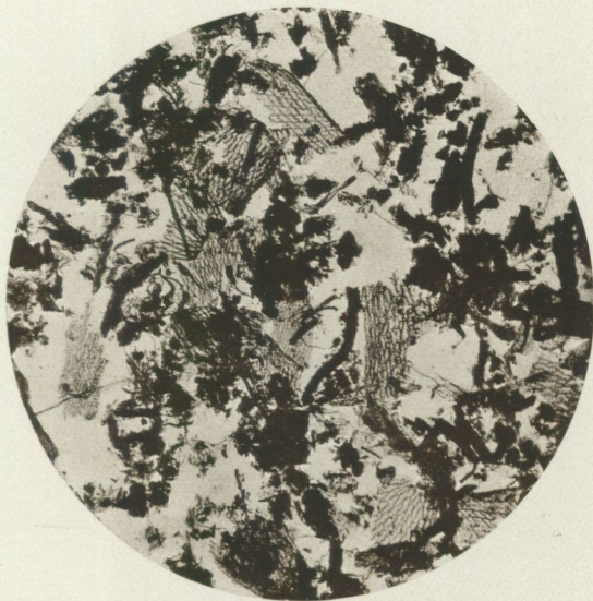
Fig. 28. Fuscumtorv H 7 R 0 V 0 . — Grundmassan består av dyklumpar och halvt sönderdelade blad och stammar av Sphagnum fuscum . Stamstyckena äro i allmänhet fyllda av humusämnen.
