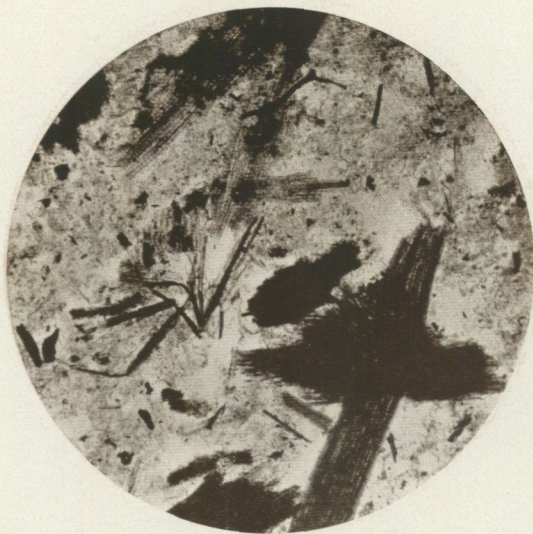
Fig. 34. Tallmossstorv H_9F_0R_0V_2 . — Grundmassan är en i det närmaste strukturlös vitmossdy. I denna kolpartiklar samt ved och bark av tall.
