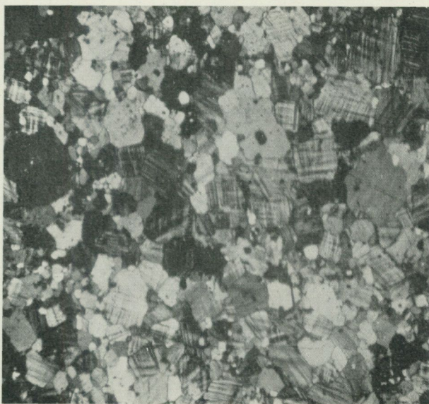
Fig. 9. Mikrofotografi av kalileptit från trakten N om Lillsjön, Doverstorpsområdet. Nicoller +. Förstoring 16 ggr.
