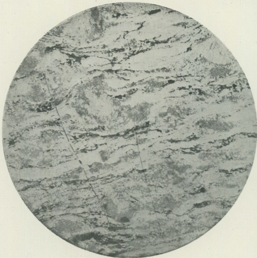
Fig. 26. Åmålsgranit. Söljetorp, Stavnäs socken. Mikrofoto med vanligt ljus. \times 5 . [ Åmåls granite, gneissically schistose. ]
