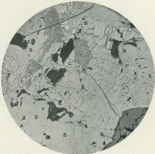
Fig. 12. Kopparmalm, Attjek, Jokkmokk. Mikrofoto., refl. ljus, \times 50 . Bornit (B) med covellin (C), delvis i lameller delvis såsom droppar i kopparglans (t. h. på bilden). Ljusgrått är chrysokolla (K), dels i ådror, dels emellan covellinlamellerna. Q är kvarts. [Copper ore, Attjek, Jokkmokk, Microfoto., refl. light, \times 50 . Bornite (B), with covellite (C), partly lamellar, partly as drops in chalcocite (to the right in the picture). Light gray is chrysokolla (K), as veins, and between the lamellae of covellite.]
