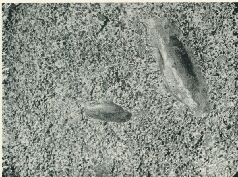
Fig. 2. Järnoolit med marina musslor. Oolitkornen äro sekundärt anrikade och starkt glättade. De ligga inbäddade i relativt ren kalkspat. Kurremölla. (Foto 276.) — 5 x.
