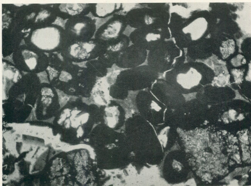
Fig. 10. Järnoolit med kvartskorn. Nedtill å bilden samt i några oolitkorn siderit. Den chamoisitiska substansen i oolitkornen är av annan beskaffenhet än den i fyllnadsmassan. Baldringevägen, Fyledalen. (Pr. 3070. F. 479.) — 60 x.
