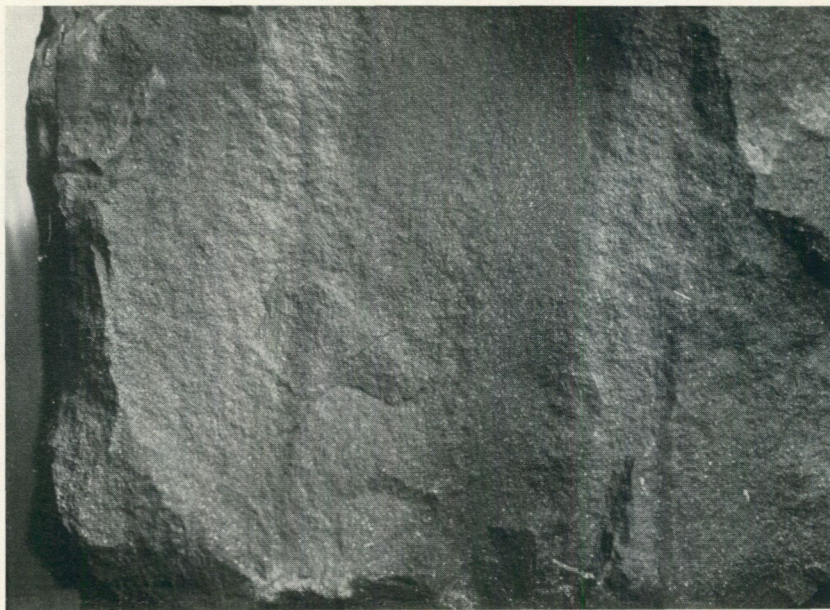
Fig. 4. Bandad grå och gråsvart oolitmalm, rik på järnkarbonat. Kurremölla 5. (F. 625.) — Nat. storlek. Striped, bright and dark gray iron oolite, rich on iron carbonate.
