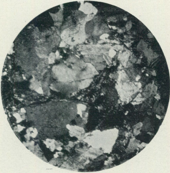
Fig. 22. Mikrofotografi av mindre krossat granitparti, södra vägprofilen, Hallen. — Förstoring 16 ggr; korsade nicoller.
