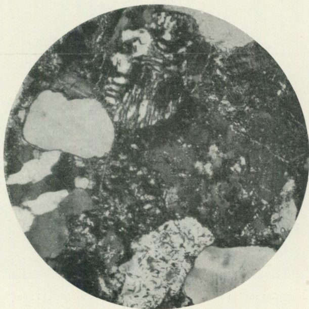
Fig. 16. Mikrofotografi av röd sparagmitsandsten från Sörånäset. Förstoring 60 ggr; korsade nicoller. Ett rundat fragment av granofyr synes.
