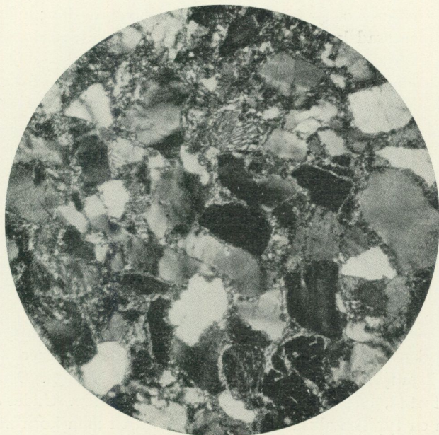
Fig. 14. Sparagmitsandsten, finkornigare, Trollklintens NV sida. Små granofyrfragment m. m. Korsade nicoller. Förstoring 35 ggr.
