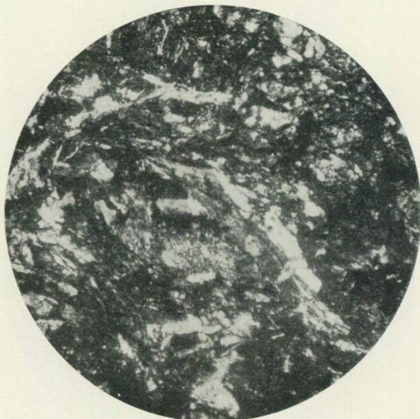
Fig. 16. Grönstensparti i granitmyloniten; delvis bibehållen gabbrodiabasstruktur. Korsade nicoller, förstoring 35 ggr. — Älviken.
