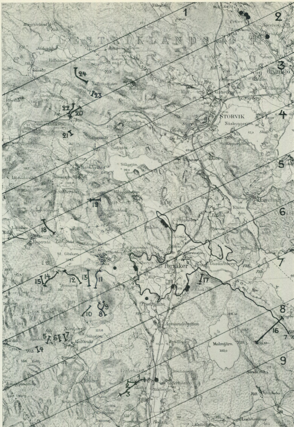
Fig. 9. Karta i skalan 1 : 125 000 över de västra delarna av kartbladet Storvik. De grova linjerna med siffrorna 1—24 angiva avvägninglinjer, längs vilka strandmärken förtecknats enl. Tabell I. De fina linjerna äro isobaslinjer i ONO—VSV med nummer enligt reduktionsdiagrammet fig. 17, sid. 32. Avståndet mellan dem är 2,5 km. Kurvlinjen markerar LG 2 -nivån, 79 m ö. h., och de svarta prickarna fyndplatser för trindyox och slagteknikyox (jfr ss. 80 och 112).
