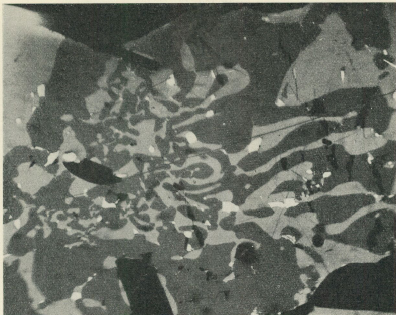
Abb. 1. Verwachsung von Fahlerz (dunkelgrau) und Bleiglanz (grauweiss). Ged. Wismuth (reinweiss) in kleinen unregelmässigen Körnern. Vergr. 260:1. Ölimmersion.
