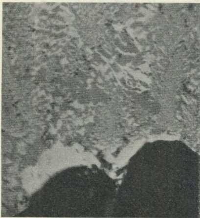
Abb. 4. Feinverteilte Gudmundit-Magnetkiesverwachsung (Gudmundit weiss, Magnetkies grau). Vergr. 850:1. Ölimmersion.
