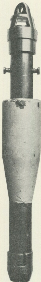
Fig. 2. Rörlod av exkursionsmodell med metallventil, använt vid de föreliggande fältarbetena. 1 : 2.
