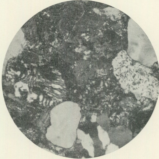
Fig. 39. Mikrofotografie des roten Sparagmitsandsteins von Sörånäset. Ein gerundetes Fragment von Granophyr. Vergr. 60 \times ; gekreuzte Nicols.
