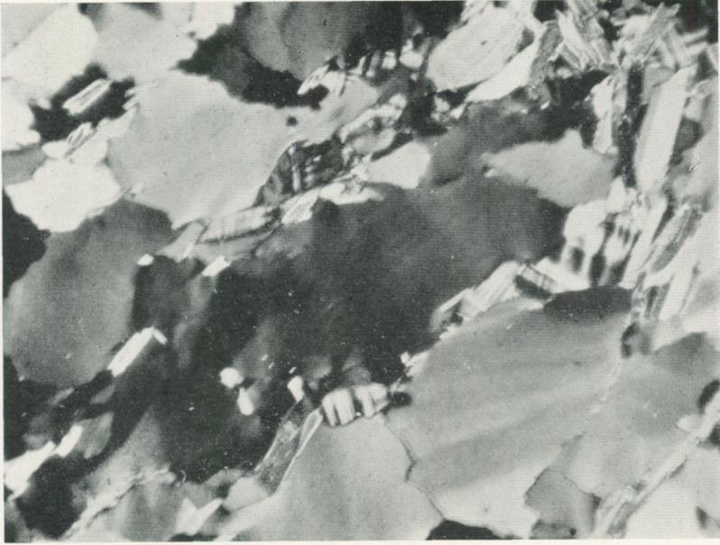
Fig. 13. Mikrofoto av kvartsit med sericit och mikroclin, Al. Kuusivaara, kors. Nik., \times 40 . (Photomicrograph of recrystallized quartzite with sericite and microcline, Al. Kuusivaara, Nic. cross., \times 40 ).
