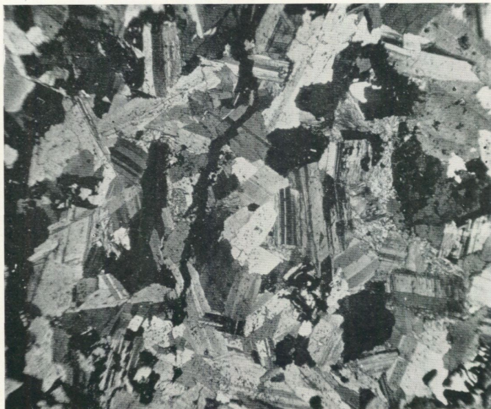
Fig. 15. Mikrofoto av normal leukodiabas, bäckravinen 3 km SV om Nalmoinen, kors. Nik., \times 7 . Albitlister med ofitisk amfibol (t. hög. och t. vänst. om mitten).
