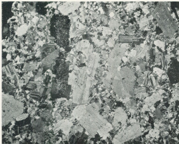
Fig. 17. Mikrofoto av karbonatisk leukodiabas, V om Teukavaara, kors. Nik., \times 7 . Grov, frisk albit med mellanmassa av albit, kvarts och karbonat. (Photomicrograph of carbonate-bearing leuko-diabase, W. of Teukavaara. Nic. cross., \times 7 . Coarse, fresh albite with groundmass of albite, quartz, and carbonate).
