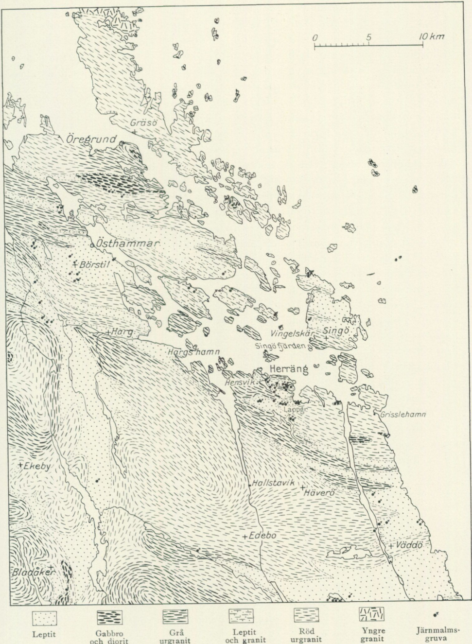
Fig. 1. Berggrunden runt Herrängsfältet (efter A. E. Törnebohm). Skala 1 : 300 000. Map of the district round the Herräng field.
