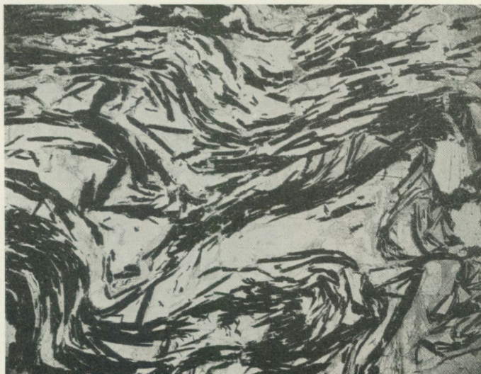
Fig. 28. Småveckad blodstensmalm, Åsbobergsgruvan, 454 m:s avvägning. Först. 6 ×. 1 nic. Gekräuselles Hämatiterz, Åsboberggrube, 454 m Tiefe. Vergr. 6 ×. 1 Nic.
