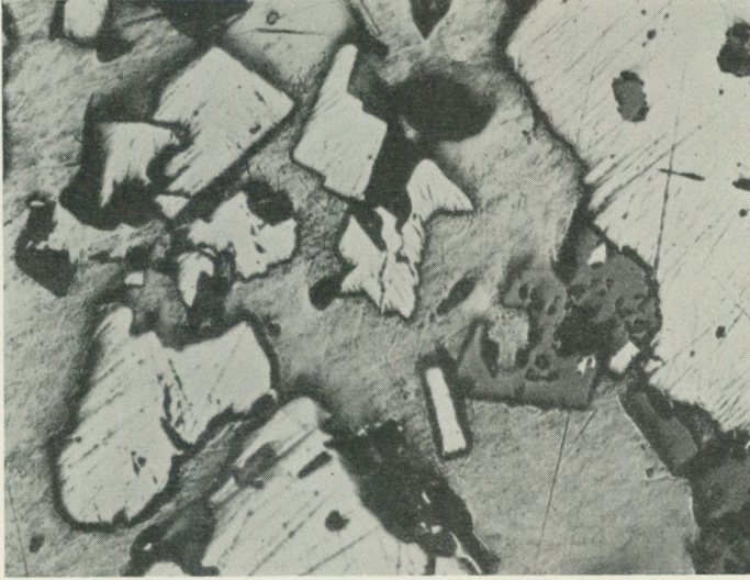
Fig. 37. Sulfidmalm, Långgruvan på 306 m:s avvägning. Mikrofoto av polerprov. Först. 150 \times . Idiomorfa kristaller av svavelkis och magnetit ligga inbäddade i kopparkis.
