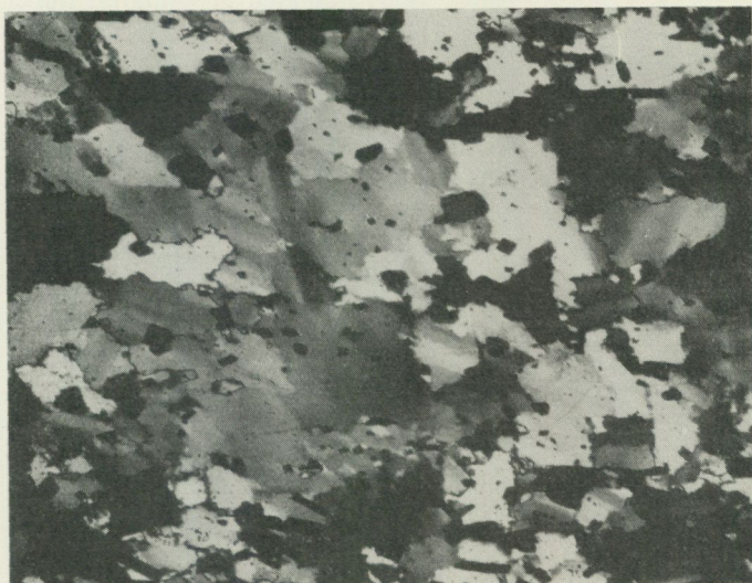
Fig. 23. Kvantsskikt i kvartsrandig blodstensmalm. Först. 30 \times . Kors. nic. Quarzschrift in quarzgebändertem Hämatiterz. Vergl. 30 \times . Nic. +.
