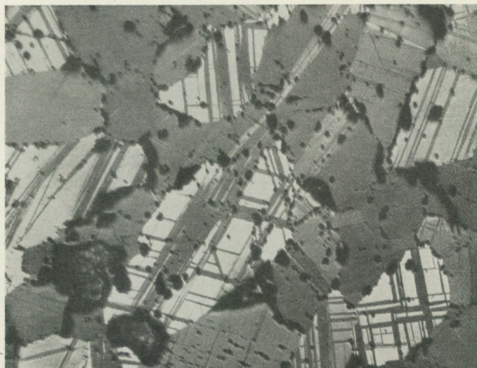
Fig. 19. Kwartsrandig blodsten, Övre Kärrgruvorna. Mikrofoto av polerprov. Först. 50 ×. Kors. nic.
