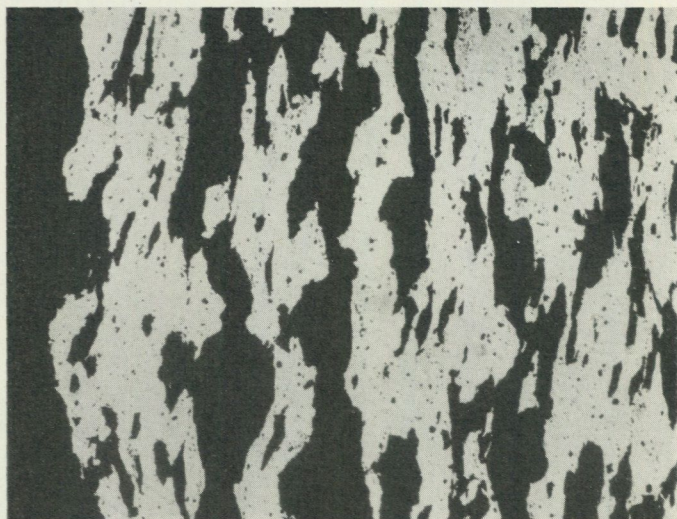
Fig. 22. Malmrikt kvartsskikt i Troilusmalmen på 350 m:s avvägning. Först. 50 \times . 1 nic. Erzreiche Quarzschicht im sog. Troilusergz der Oberen Kärrgruben, 350 m Tiefe. Vergr. 50 \times . 1 nic.
