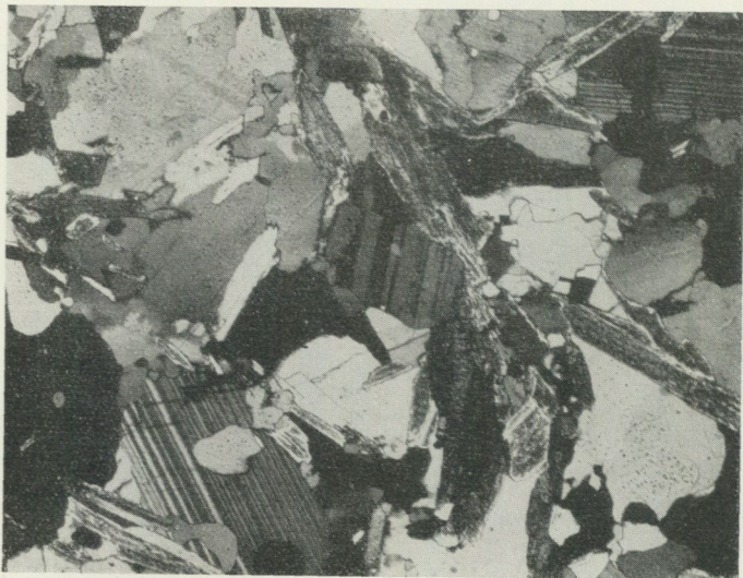
Fig. 10. Glimmergnejs, Ö om Åsboberg. Först. 30 \times . Kors. nic Glimmergnejs, östlich der Åsboberggrube. Vergr. 30 \times . Nic. +.
