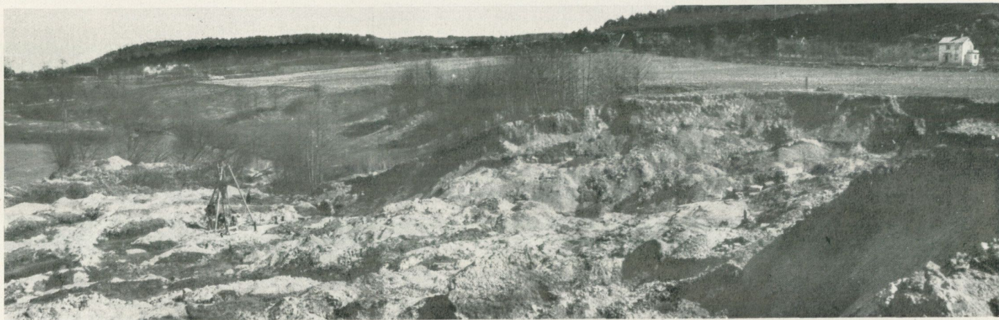
Fig. 9. Säveåskredet från västra skredkanten med Säveån längst till vänster. Stubbrytaren står vid borrhål 2, som är under arbete. De mörka partierna i skredärret utgörs av grässvåls- och matjordsresterna på de utglidna skollorna, de ljusa av såplera, vilka senare dagen efter skredet hade en skarp krönkontur och glatta glidyterepade sidor. Denna ytform förstördes emellertid genom lerans sönderfrysning under vintern. Foto 18/4 45 Carl Caldenius.
