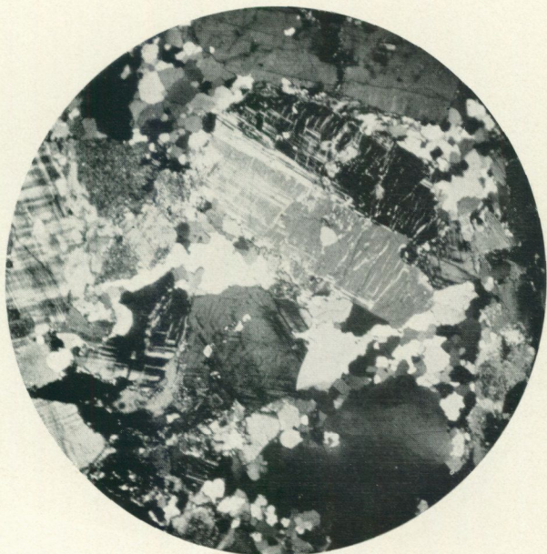
Fig. 60. Medelkornig något porfyrisk, grå granit från Skörje i Backaryds socken, Blekinge, Nr 89. Nära mitten en större karlsbadertvilling av mikroclinperthit med smärre inneslutna kvartskorn och strimmor av perthitiskt utskild albit. Förstoring 15 ggr, korsade nicoller.
