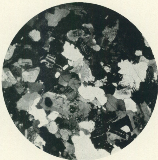
Fig. 51. Typisk finkornig Bohusgranit med genomsnittlig kornstorlek av 0,5—1 mm, Ramsvik i Lyse socken, Nr 46; grå granit. De blanka ljusa fälten utgöres av kvarts med ganska buktande korngränser; de rutiga, svart-vita kornen äro mikroklinperthit och de finstrimmiga ljusgrå plagioklas med tvillingstreckning. Förstoring 15 ggr, korsade nicoller.
