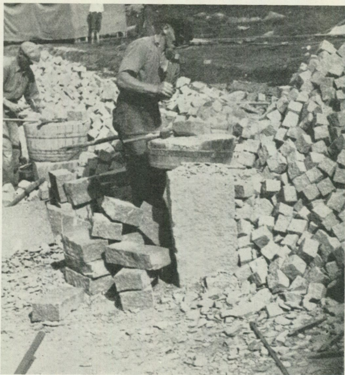
Fig. 47. Smågatstenschuggning vid Eds storbrott, Bro socken. I förgrunden till vänster om tunnan befinna sig smågatstensämnen i dimensionerna 9 \times 18 \times 36 cm med kortändan i borstens riktning. Ett dylikt ämne har »bräcks» efter borsten till dimensionerna 9 \times 18 \times 18 cm och ett av delämnena ligger på tunnan och klyves nu med handsläggen efter föregående ritsning längs med stående klovet. Putshammaren ligger på tunnan. Den färdiga smågatstenen har god form.
