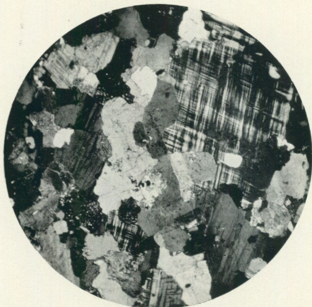
Fig. 57. Medelkornig-øjämnkornig Bohusgranit med starkt växlande kornstorlek; Lia storbrott i Skee socken, Nr 23. Man urskiljer en stor »rutig» mikrokliperthit, rundade små kvartskorn och »formlösa» plagioklas- och mikroklivindivider. Förstoring 15 ggr, korsade nicoller.
