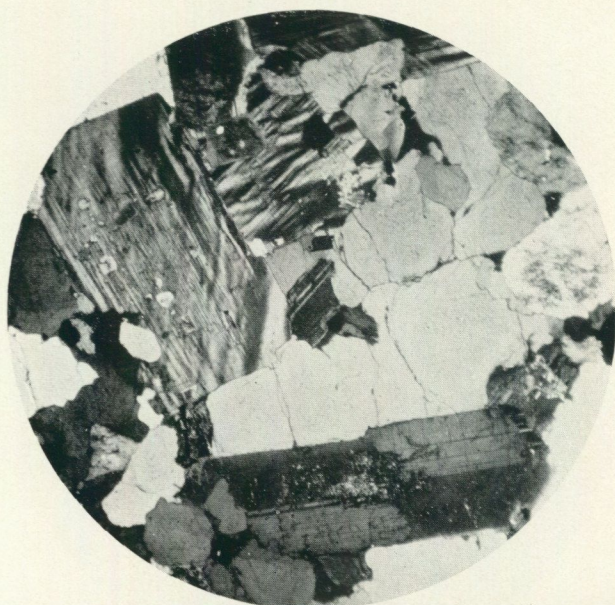
Fig. 58. Hypidiomorfkornig struktur i Bohusgranit från Dammen i Krokstrandsdistriktet, Skee socken, Nr 25. Mikrokliperthit (vågigt tvillingstreckad) och plagioklas (finstreckad med mörka fält) uppvisa ganska utpräglad idiomorfi, egenform, medan kvartsen uppträder i tvenne generationer, dels små 6-sidiga korn, ibland inneslutna i fältspaterna, dels avgjutande oregelbundna korn (de stora ljusa fälten). Förstoring 15 ggr, korsade nicoller.
