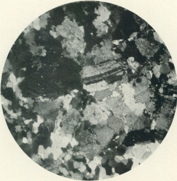
Fig. 63. Finkornig—medelkornig röd granit från Skrika i Fliseryds socken, Småland, Nr 80. Nära mitten en någorlunda idiomorf plagioklas med typisk, grov tvillingstreckning, i övrigt hög halt av mikroklin. Kvartsfälten äro starkt granulerade. Förstoring 15 ggr, korsade nicoller.
