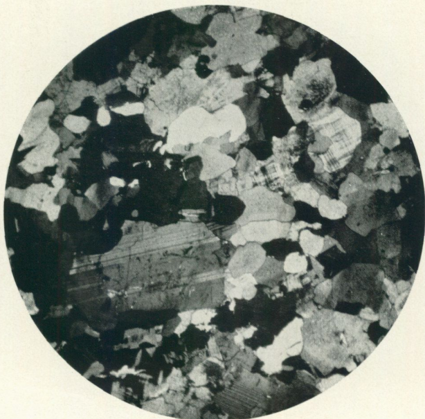
Fig. 56. Finkornig Bohusgranit, röd, N. Grundsund i Lyse socken, Nr 56. Det finstrimmiga större mineralkornet nära mittpunkten utgöres av tvillinglamellerad plagioklas. Förstoring 15 ggr, korsade nicoller.
