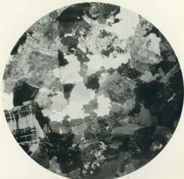
Fig. 54. Finkornig—medelkornig Bohusgranit, gråröd; Kämpersvik i Tanums socken, Nr 1. Kvartsen, de ljusa kornen i mittpartiet, har starkt implicerade gränser. Ett flertal korn utgöres av saussuritiserad plagioklas. Förstoring 15 ggr, korsade nicoller.
