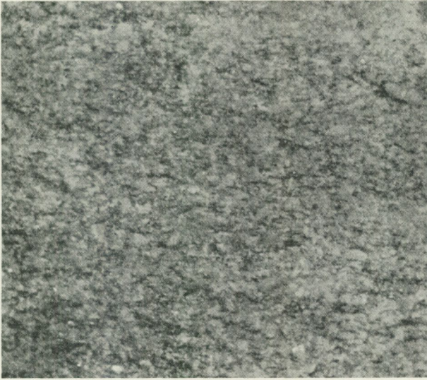
Fig. 23. Bohusgranit med utpräglad randighet, åstadkommen genom parallell orientering av särskilt glimmermineralen. Skär N om Snartkalven i Tjärnö socken. Naturlig storlek.
