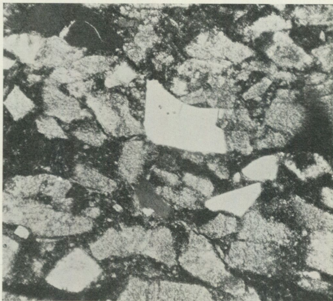
Fig. 4. Centralt parti av samma tunnslip som i fig. 3. Först. 60 \times . Kors. nic. De grå kornen utgöras huvudsakligen av porfyr, de ljusa och mörka av kvarts, svarta flagor av omvandlad biotit. — Central portion of the thin section shown in fig. 3. Nic. +. \times 60. Gray fragments mainly of porphyry, light and dark ones of quartz, and black flakes of altered biotite.
