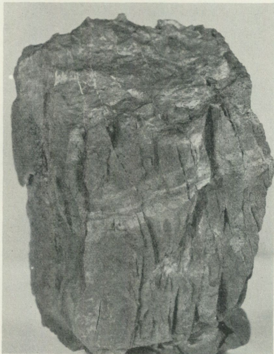
Fig. 10. Kalkrik skiffer med perpendikulär förskiffring. Översta fossilhorisonten i Bångåsenserien. 1/1. — Piece of calcareous shale with perpendicular schistosity and jointing. Uppermost fossil-bearing horizon of the Bångåsen series. Nat. size.
