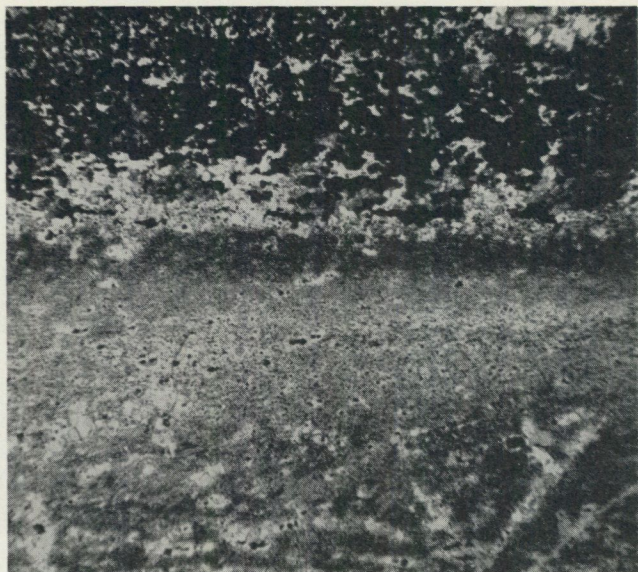
Fig. 12. Järnkiselandig blodstensmalm. Slipprov \times 12 . Bildens övre del består av malmrand med diopsid och karbonatmineral. Omedelbart nedanför malmranden en mörk strimma av järnglansstoff. Därunder är utrensningen längre framskriden, medan bildens nedersta del åter innehåller rikligt med järnglansstoff.
