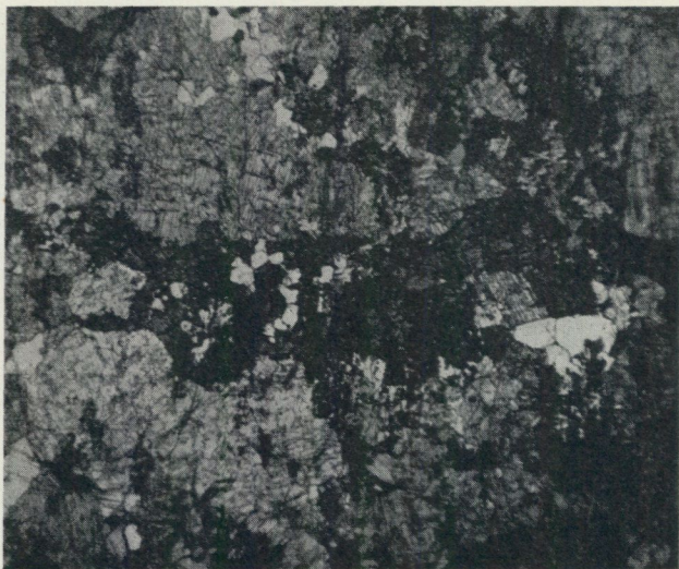
Fig. 21. Skarn som uppträder i samband med skarnrandig malm. Dbh 1—255.20 m. Slipprov \times 12 . Bilden visar en grundmassa av diopsid. Det mörka mineralet är epidot. I bildens högra del omsluta två epidotkorn var sitt diopsidkorn. I bildens vänstra del har epidot utefter korngränserna breccieformigt vuxit in mellan diopsidkornen.
