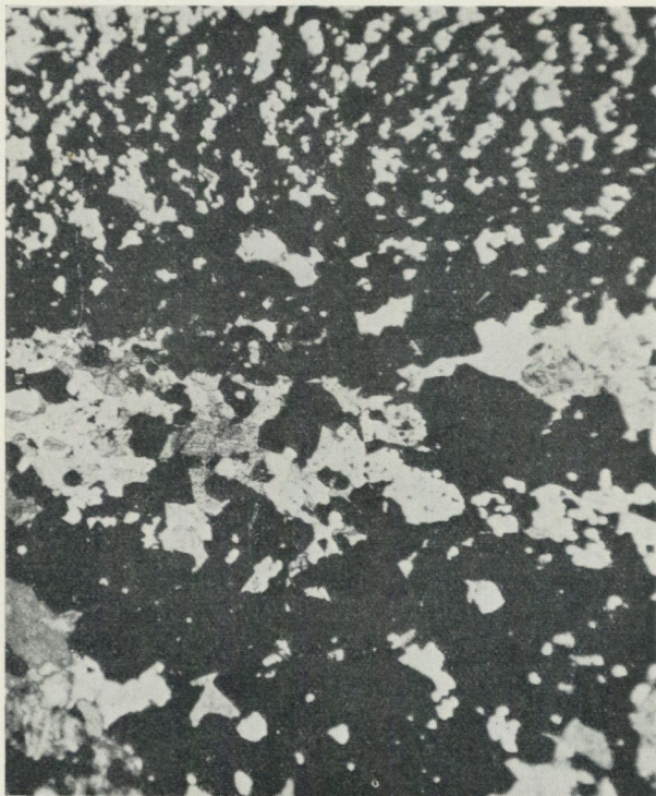
Fig. 6. Kvartsrandig svartmalm. Dbh 1—322.55 m. Slipprov \times 20 . Bilden återger ett tvärsnitt genom en ung. 1 cm bred malmrand. Den övre hälften av malmranden är karbonatfri och malmen har utrensningsstruktur. Inom den nedre hälften är karbonathalten rätt hög. Här har en förgrovning och aggregation av magnetitkornen ägt rum.
