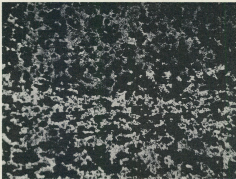
Fig. 20. Kvartsrandig svartmalm Dbh 1—333.80 m. Slipprov \times 28 . Bildens övre hälft upptas av en genom skarnbildning resorberad malmrand. Den grå grundmassan utgöres i huvudsak av diopsid. Genom omkristallisation av den efter skarnbildningen kvarblivna malmsubstansen ha magnetitkristaller bildats. Bildens nedre hälft upptas av kvartsrand med en exceptionellt hög malmhalt. Malmsubstansen har undergått en kraftig sammelkristallisation, vilken givit upphov till malmkorn med utpräglad utrensingsstruktur.
