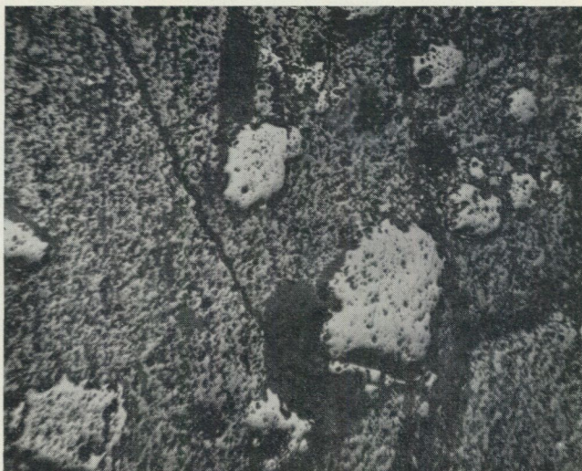
Fig. 15. Järnglanskorn uppkomna i ytterst finkornig svartmalm. Provet från varphög vid Långgruvans norra ända. Polerprov \times 40 . På bilden äro de större, vita kornen järnglanskorn, medan magnetiten har grå färg.
