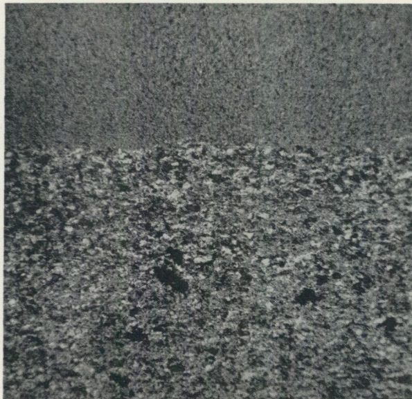
Fig. 4. Tät fyllitisk bergart. Dbh 1. Slipprov \times 20 . Bilden visar kontakten mellan två skikt med olika kornstorlek. Vardera skiktet består av kvarts, fältspat och biotit. De svarta kornen, som äro grövre än grundmassan i det undre skiktet, utgöras av malmkorn.
