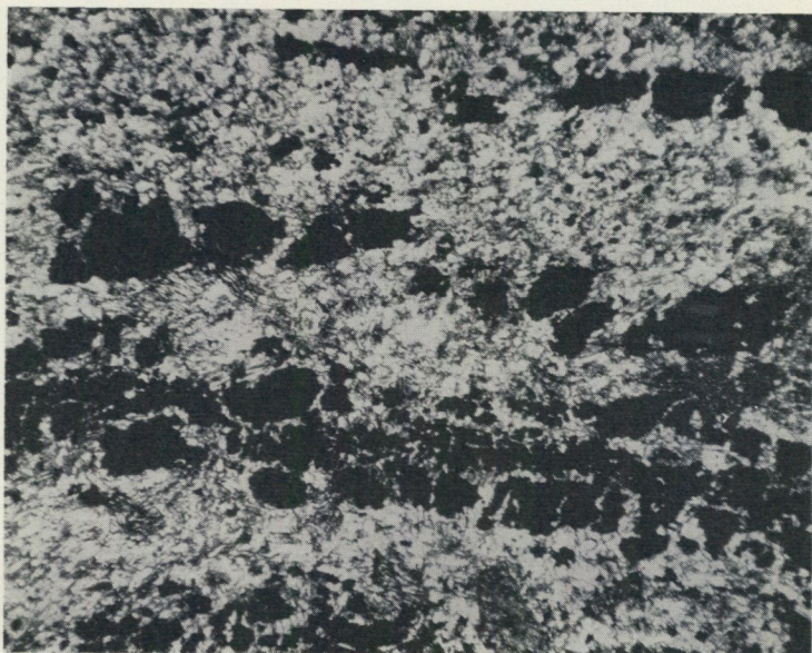
Fig. 19. Skarnrandig malm. Dbh 1—290.10 m. Slipprov \times 12 . Bilden visar stycken av malmränder, vilka återstå efter det malmen partiellt förtärts genom skarnbildning. Den ljusa grundmassan består av tremolit. Vid nedre kanten ett diopsidkorn.
