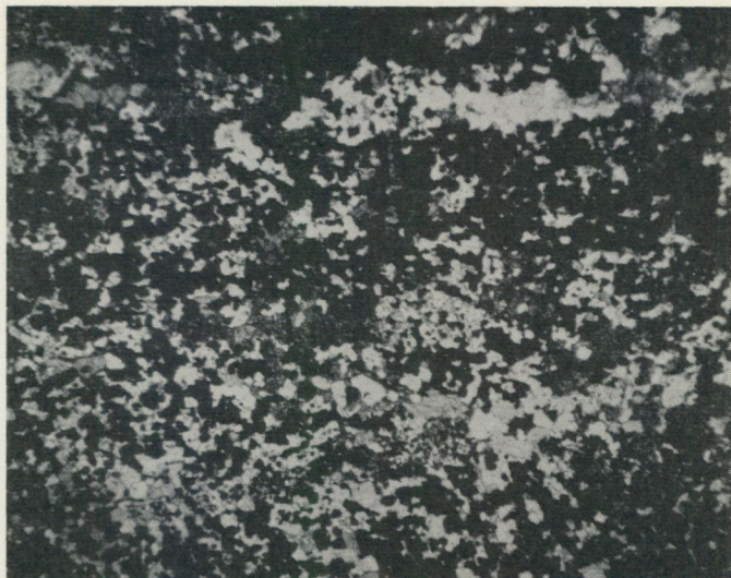
Fig. 11. Kvartsrandig svartmalm från dbh 1—363.30 m. Slipprov \times 12 . Bilden visar över hela provet någorlunda jämnt fördelade magnetitkorn, av vilka flertalet har mer eller mindre utpräglad utrensningsstruktur. De ljusa kornen mellan magnetitkornen utgöras av kvarts, fältspat, calcit och enstaka diopsidkorn. Skillnaden mellan malm- och kvartsränder har hävts genom substansutbyte och stark sammalkristallisation.
