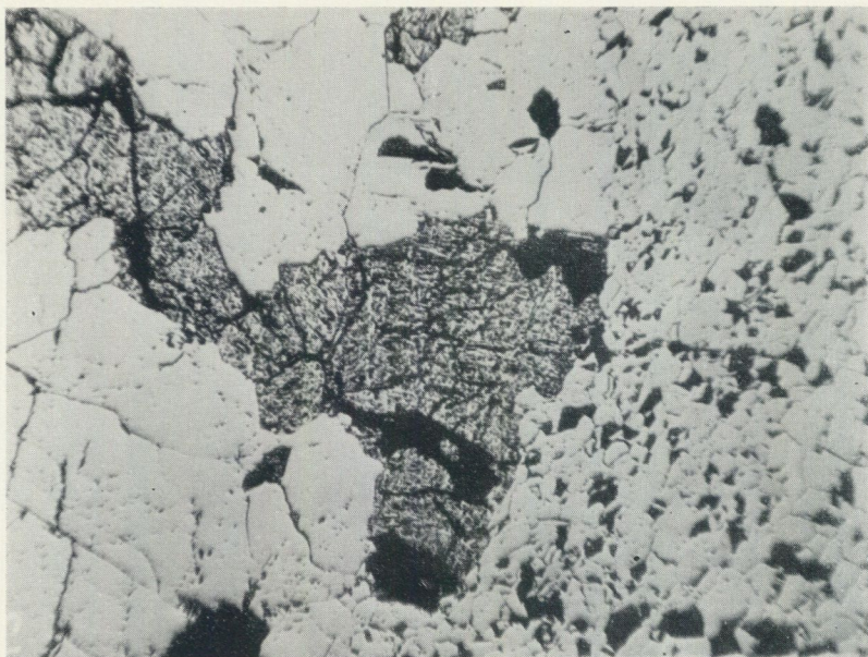
Fig. 21. Vittrad blodsten, borrhål 22, 21.25 m. Polerprov, vanl. ljus, 46\times . I den grova hämatiten fragment av martit. Helsvarta fält utgöres av håligheter.
