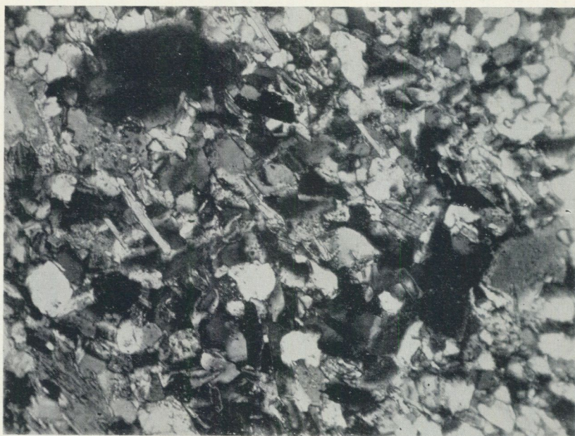
Fig. 13. Leptit, borrhål 58116, 264.90 m. Slipprov, + nic., 75 ×. Kvarts (vit), mikroklin (grå), plagioklas (grå), biotit (fjäll och oregelbundna mörka korn) samt järnoxid (svart).
