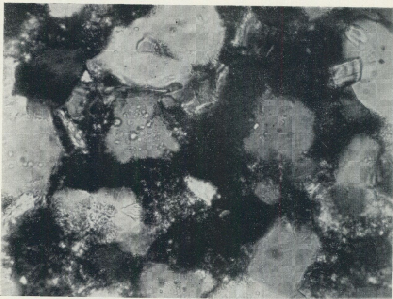
Fig. 17. Kaolinlera, borrhål 58116, 270.17 m. Slipprov, + nic., 340 ×. Kvarts och muskovit omgivas av kaolinit och limonit (svart).
