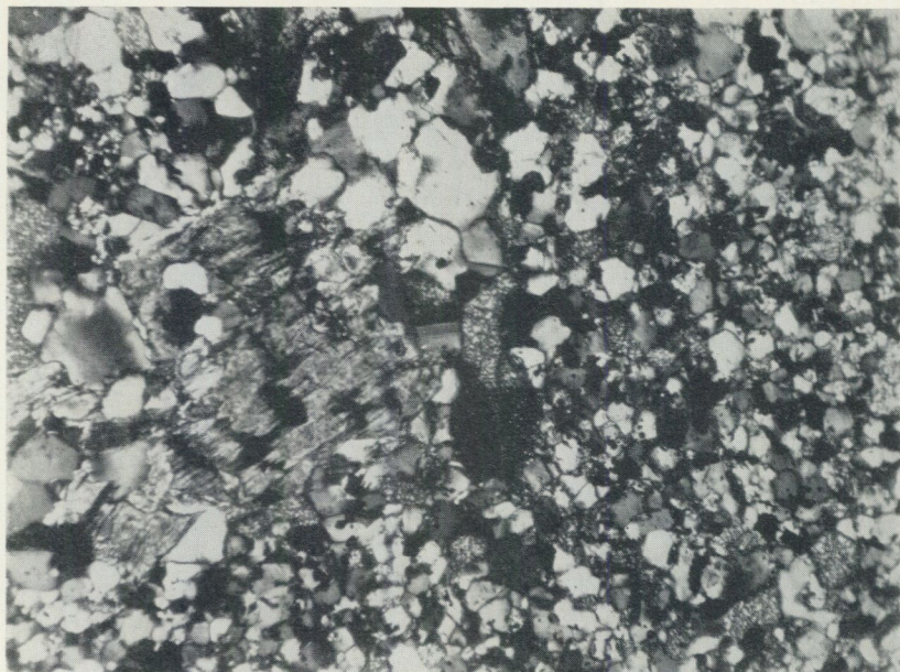
Fig. 3. Vittrad leptit, borrhål 58116, 29.30 m. Slipprov, + nic., 75 \times . Kvarts, mikroklin, hämatit (svart), biotit (i vänstra delen av bilden) samt ett finfjälligt glimmermineral.
