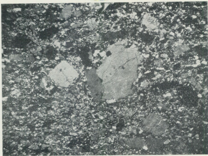
Fig. 8. Aplitisk facies av syeniten. Samma fyndort, som återgivits i fig. 7, men med strökorn av ortoklasperit. \times 9 , nik. +. The aplitic facies of the syenite. The same locality as in Fig. 7 but with phenocrysts of orthoclase-perthite.
