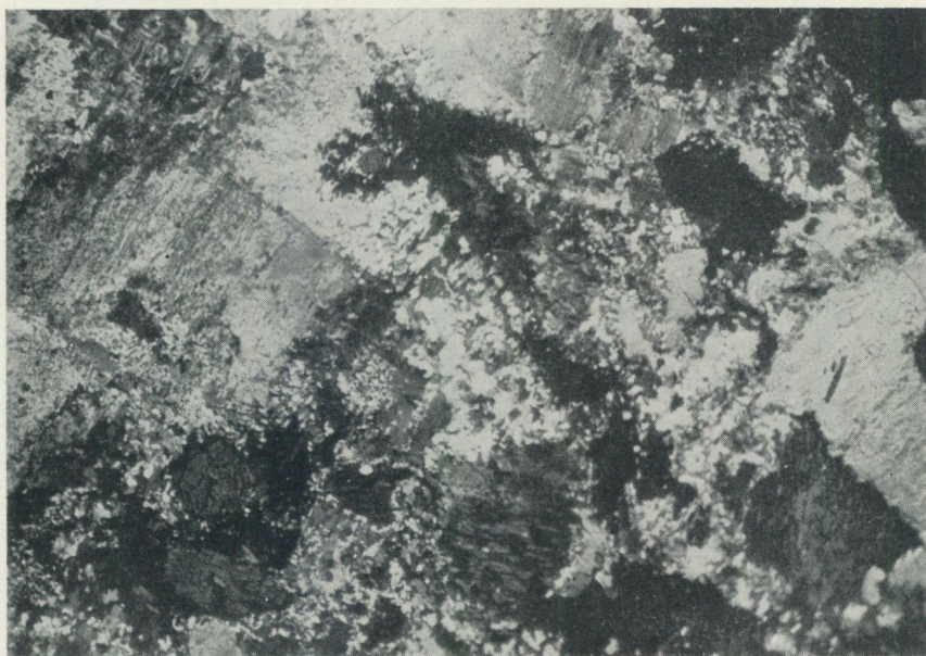
Fig. 5. Massformig syenit med krosszoner omkring större fältspatkorn. Vaggeryd. \times 8 , nik. +. Massive syenite with crushed zones surrounding larger feldspar crystals.
