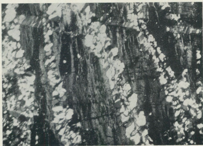
Fig. 10. Mikroklinpertit genomsatt av parallella krosszoner med granulerade kvartskorn långa stråk. Vaggeryd. \times 38 , nik. +.
