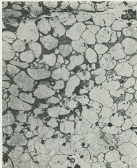
Fig. 26. Mikrofoto av Vassbomalm, grovkor-nig, i genomfallande ljus. Svart är blyglans och något zinkblände, vitt är kvarts. Skala 15: 1.
