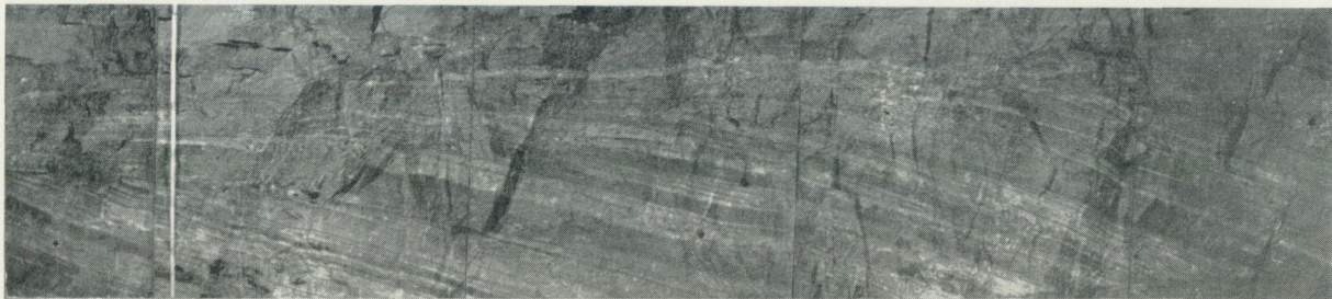
Fig. 19. Profil av gruvväggen, NE—SW, visande strömskiktning i malmsandstenen. Profilhöjd ca 1 m, längd ca 6 m.
