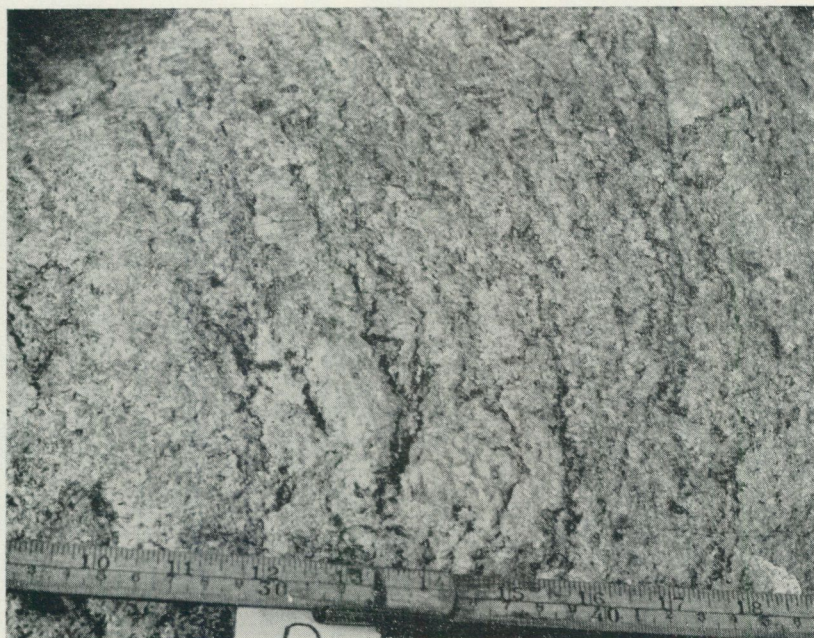
Fig. 36. Coarse, microcline-rich granitic augen-gneiss. Valsång 159.870.
