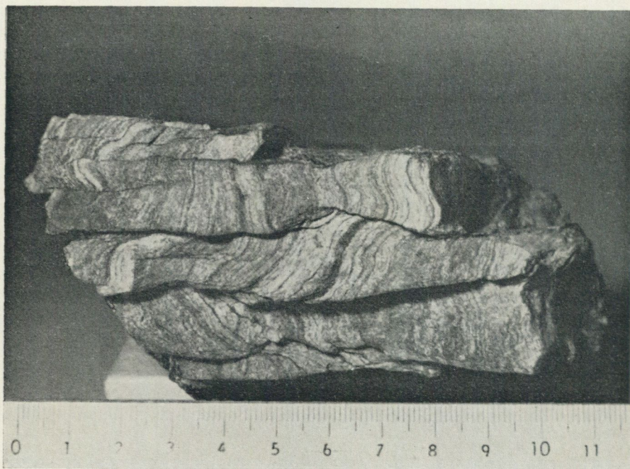
Fig 23. Kvartsfyllit med förskiffring skärande brant över lagringen. På förskiffringsytorna finns grafit, som utpressats från grafitförande skikt i bergarten. Gitotjarve.
