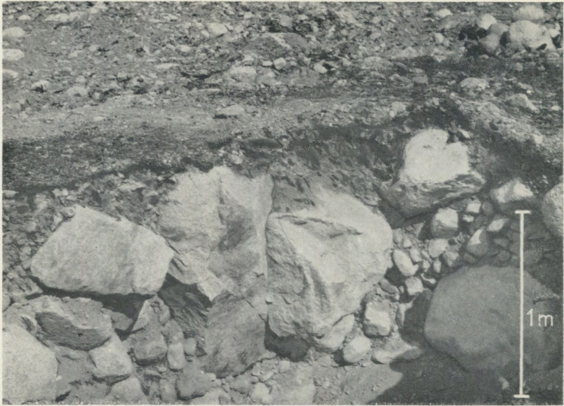
Fig. 10. Provgrop i blockterrass mellan Messaure-dammens nordöstra fäste och Nietsakårsås mynning. Överst ett tunt lager stenigt grus, därunder storblockig stenjord. G. Pettersson foto.
