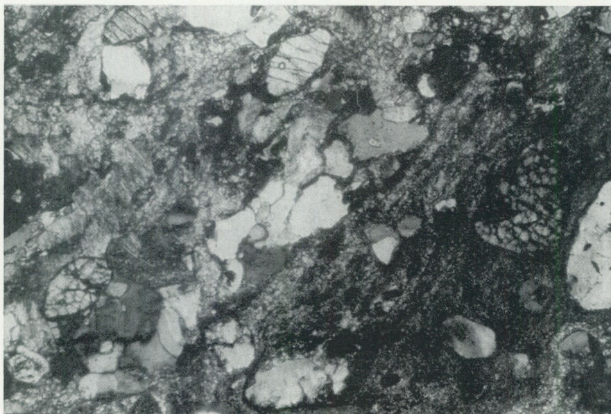
Fig. 7. Mylonitisierter Kalksilikatgneis, Bjelkesgrube. 110 X, +Nic.
