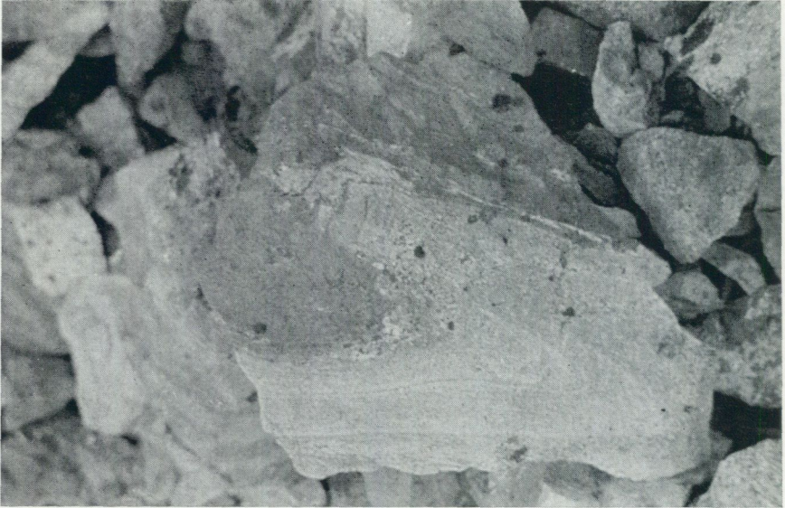
Fig. 9. Gebänderter Kalksilikatgneis mit zur Bänderung parallel verlaufender Imprägnationsvererzung (aus den Halden des Bjelkesfeldes).
