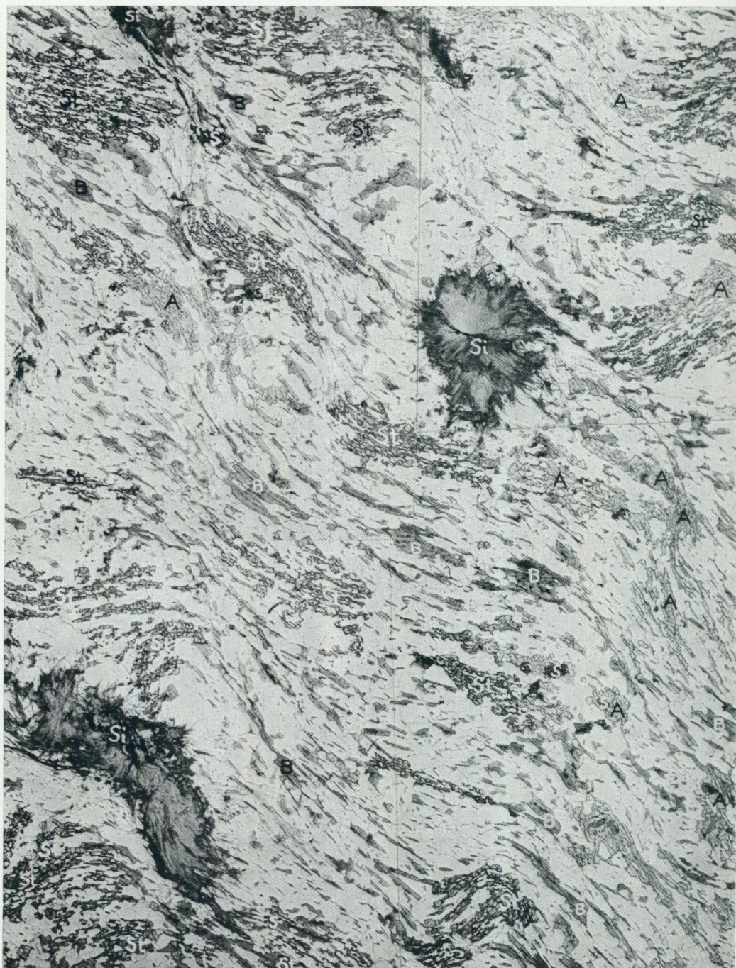
Abb. 6. Sillimanit (Si)—Andalusit (A)—Staurolith (St)—Spinell (S)—Biotit (B)—Pinit—Quarzit. Weiss: Quarz. Die gebogenen Sillimanitbüschel, Andalusit- und Staurolith-Skelette weisen auf postkristalline Deformation hin. 120 m-Sohle. Vergr. 9x, 1 Nic.
