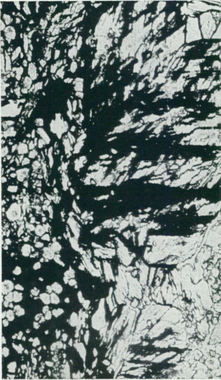
Abb. 39. Veretzter Amphibol—Granat—Skarn. Die Veretzung erfolgte hier hauptsächlich entlang Amphibol-Spaltflächen. 310 m-Sohle. Schwarz: Erz. Dünnschliff. Vergr. 50x, 1 Nic.
