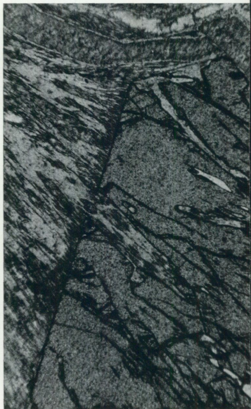
Abb. 20. Von Chlorit durchwachsender Granatporphyroblast (untere Bildhälfte). In der Chloritmasse (obere Bildhälfte): Quergehende Serpentinader. 120 m-Sohle. Vergr. 56x 1 Nic.
