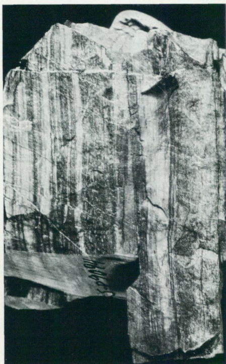
Abb. 4. Gebänderter Leptit. Angewitterte Fläche. Die dunkle Bänderung beruht auf Lagen von fein verteiltem Aktinolith, Südlich von Holn. 0,8x nat. Gr.
