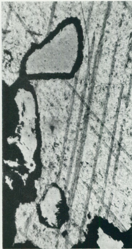
Abb. 38. Selektive Vererzung von Ophikalzit. Erz (schwarz) verdrängt den Spat (Spaltlamellen!), umgeht jedoch die Serpentinballen. 310 m-Sohle. Vergr. 160x, 1 Nic.
