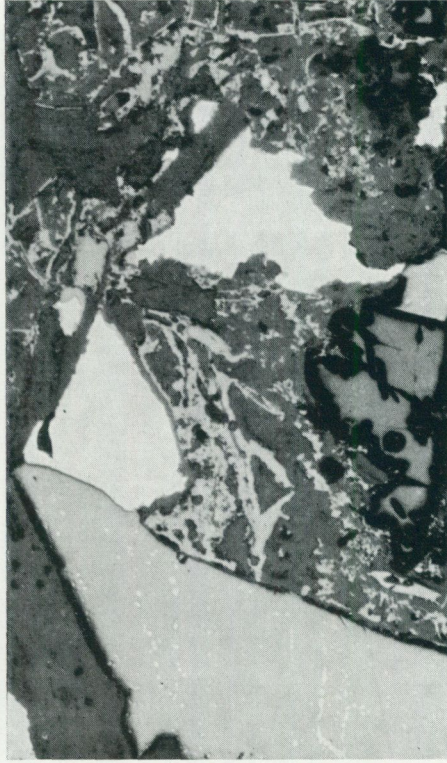
Abb 40. Zinkerz. Zinkblende (lichtgrau) mit Kupferkiesentmischung, etwas Kupferkies (weiss) im eisenreichen Spat, der zu Limonit (grau) verwittert. Rechts, dunkelgrau mit Relief: Harte Silikate. Anschliff. Vergr. 100x, 1 Nic.
