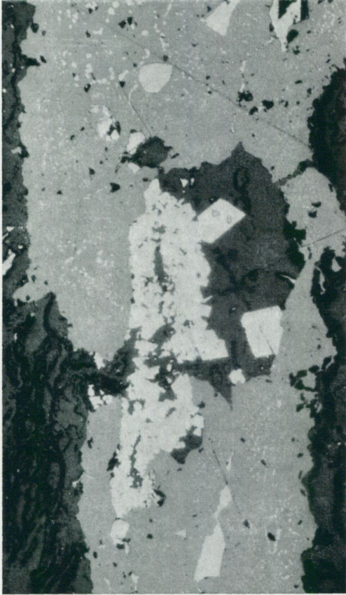
Abb. 45. Züge aus Zinkblende mit Kupferkiestropfchen umschliessen Feinpyrit (auch die wie Markasit aussehenden rhombischen Schnitte), etwas Bleiglanz und Kupferkies (beide weiss). Schwarz: Silikatische Gangart. Vergr. 100x, 1 Nic.
