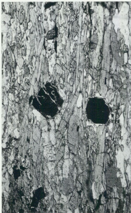
Abb. 7. Metabasit mit langprismatischer Hornblende. Schliff parallel B. Nematoblastisches Gefüge (lineares Parallelgefüge). Die opaken Sulfidminerale sind von chloritischen Reaktionssäumen umgeben. 120 m-Sohle. Vergr. 40x, 1 Nic.
