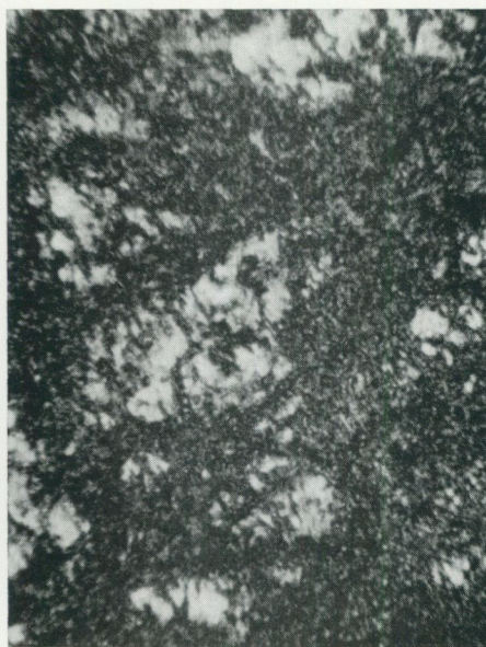
Abb. 21 d. Fast zur Gänze umgewandelter Cordierit. Umsetzungsprodukt: Feinschuppiger, farbloser Glimmer (dunkelgrau im Bild). Vergr. 56x, x Nic.
