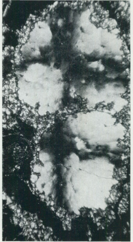
Abb. 11. Doppelmandel in Tunadiabas. Quarz (mit Sphäritenkreuz) umgeben von chloritischer Randzone. Vergr. 60x. x Nic.
