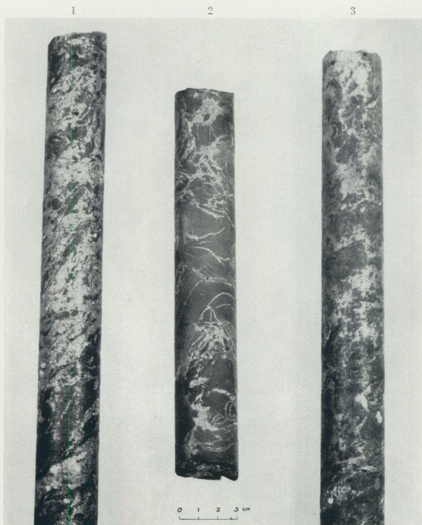
Fig. 5. Graphite schist with high content of graphite, pyrrhotite and pyrite. 1 dh 63018 85.4 m, 2 dh 62001 217.6 m, 3 dh 63018 85.6 m. Photo by B. Rönnberg.
