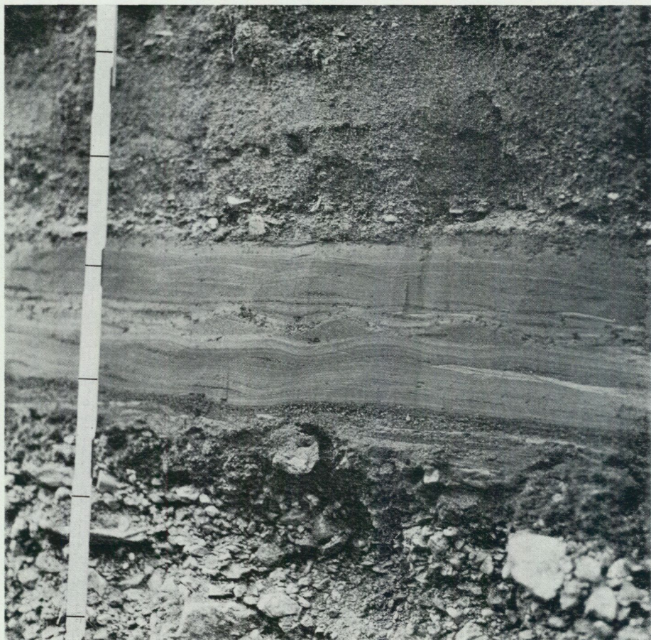
Fig. 34. Sediment med växellagrade skikt av sand, mo och mjåla i slits D III. – Foto Karin Eriksson.
