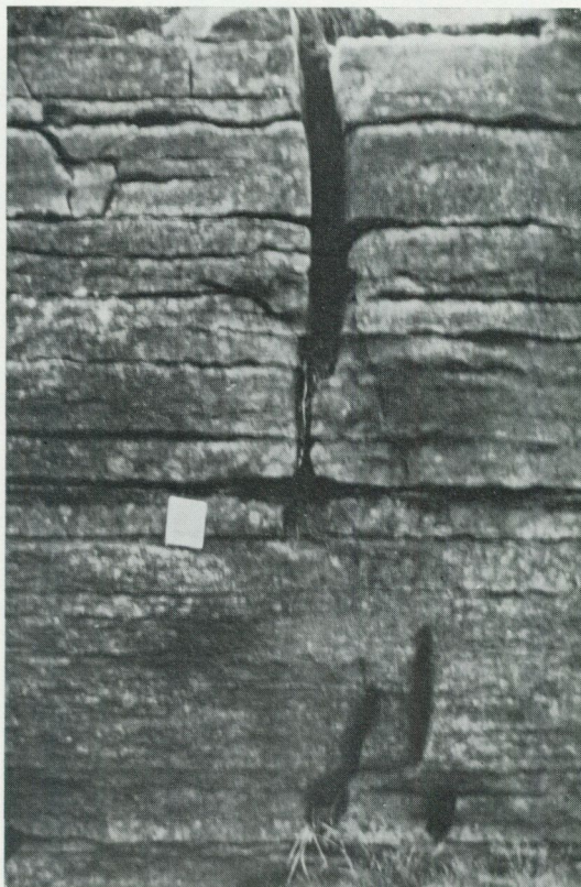
Fig. 10. Karstvittring i lodrät kalkstensvägg i stenbrott vid Vickleby. Foto J. P., dec. 1970. Karstic weathering in vertical limestone wall in a quarry at Vickleby.
