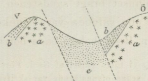
Fig. 5. Tänktt profil öfver Knappgårdskullen och Klittberget. Mellan de streckade linierna ett nedsänkt parti. a = granit, b = ortocerkalk, e = sandsten.
